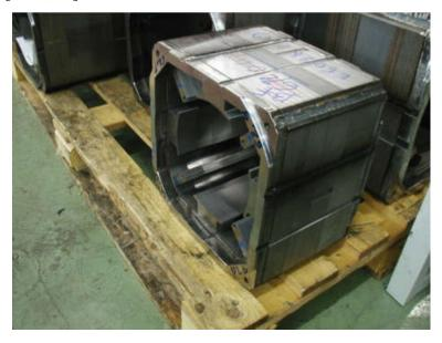
Figure I.5. Culasse, circuit magnétique statorique d'une machine à courant continu.
