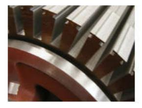
Figure I.6. Encoche sur l'induit destinée à recevoir les conducteurs dits actifs.
