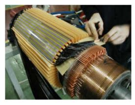
**Figure I.7.** Mise en place des conducteurs d'induit dans les encoches et soudure de ceux-ci sur le collecteur.
