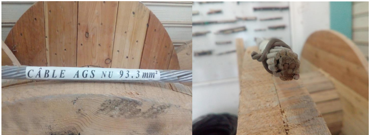
Figure1.9 : Câble AGS NU 93.3\text{mm}^2
