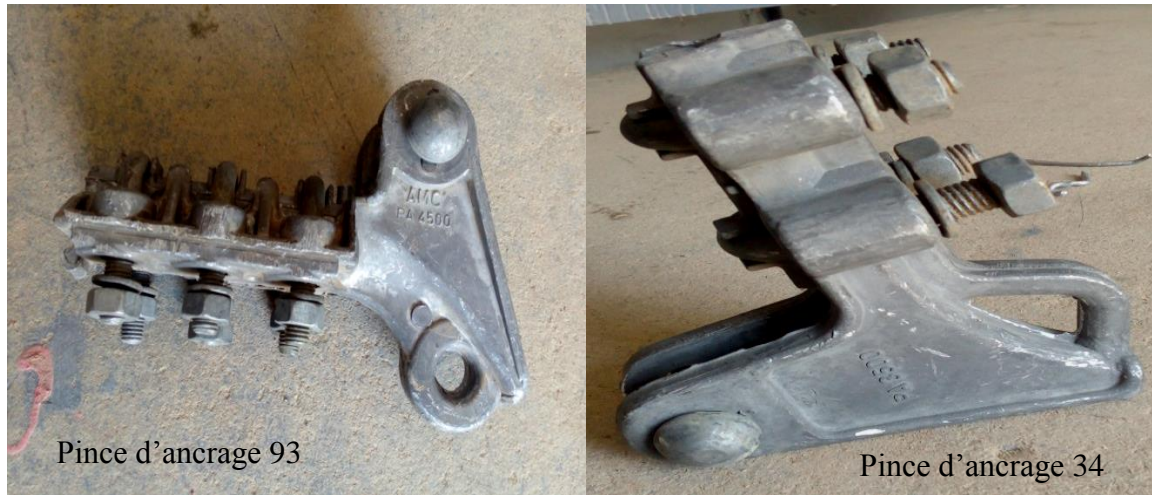
FIGURE 1.22 : Pince d'ancrage alignement MT
