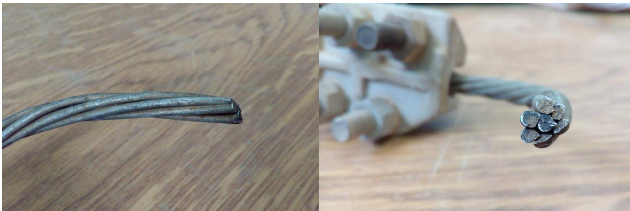
Figure1.10 : Câble AGS NU 34.4\text{mm}^2
