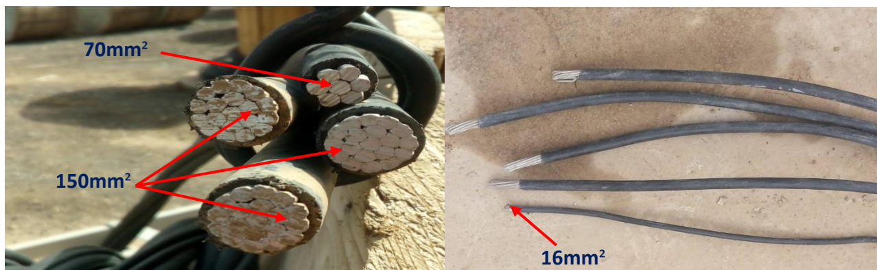
Figure1.8 : conducteur de Basse Tension 3 \times 150 + 70 + 2 \times 16 \text{ mm}^2
