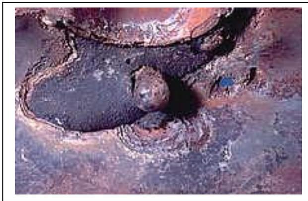
**Fig.I.8. Corrosion galvanique au niveau d'une zone de brasage entre la brasure Cu-P et le tube**
