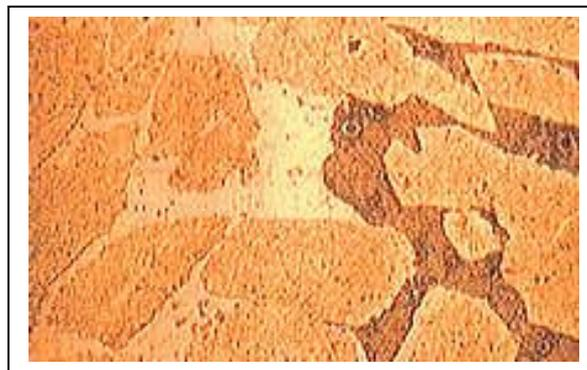
**Fig.I.7. Coupe métallographique montrant une corrosion sélective d'un laiton**
