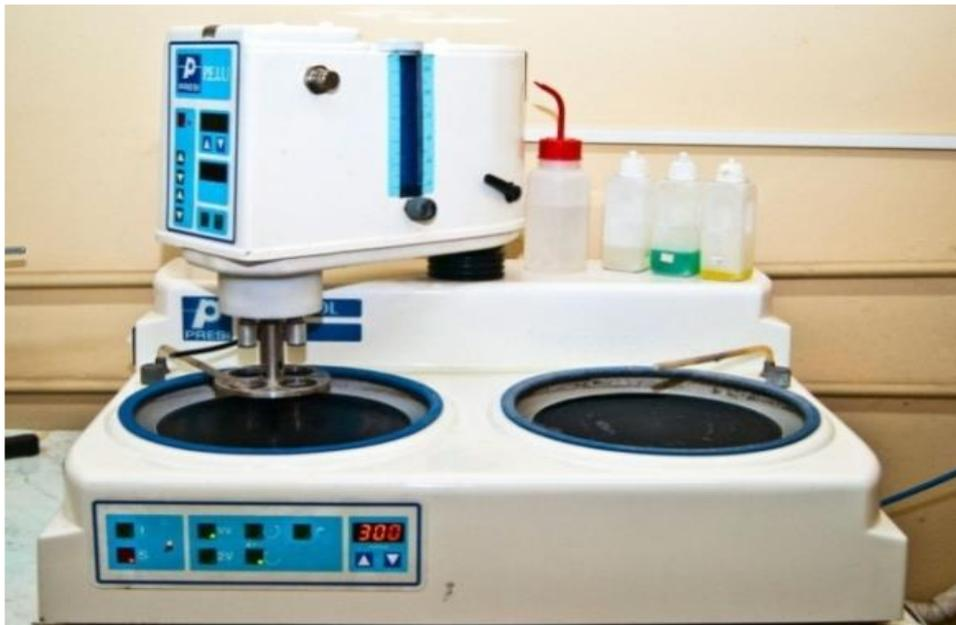
**Fig. II.1. Une polisseuse mécanique**
