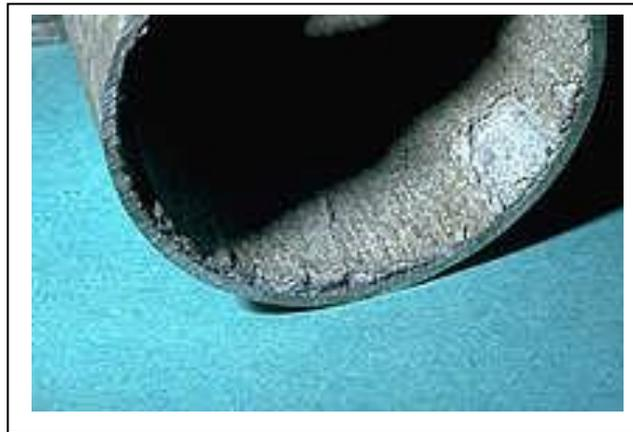
**Fig.I.4. Corrosion inter granulaire**
