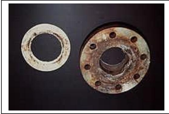
**Fig.I.5. Corrosion caverneuse d'un acier allié sous un joint**
