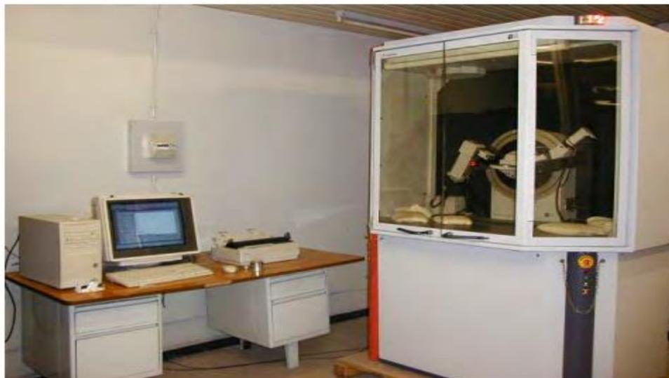
**Figure II.5** : diffractomètre de type D8 Advance- Bruker
