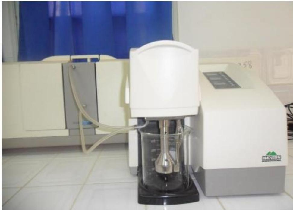
**Figure II.8:** granulomètre laser Malvern Mastersizer 2000/3000.
