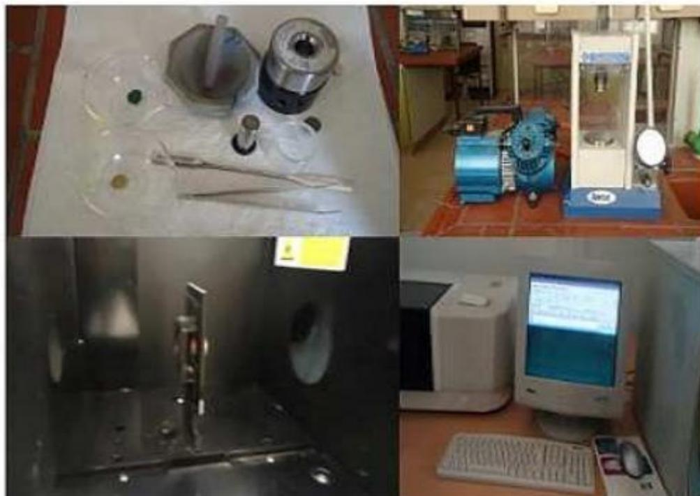
**Figure II.7** : spectromètre Infrarouge à transformée de Fourier
