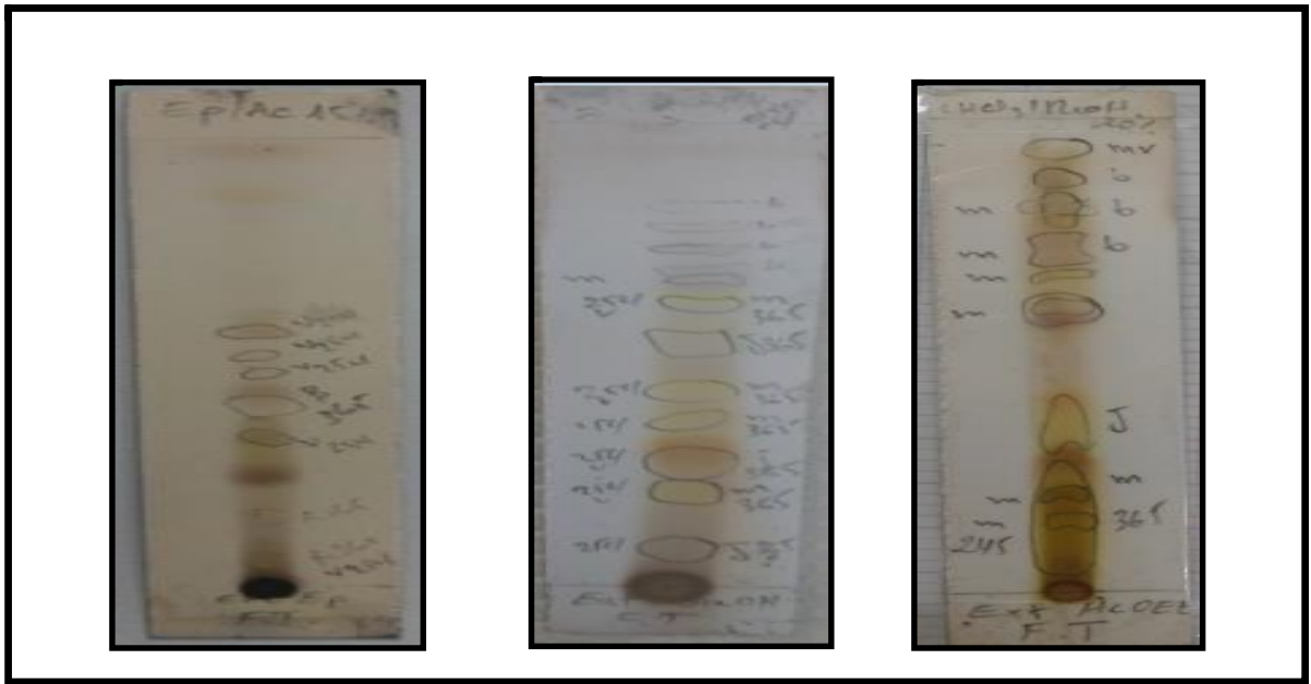
Figure III .5 : Chromatogrammes des extraits obtenus (EP, AcOEt et n -BuOH) dans différents systèmes d'élution
