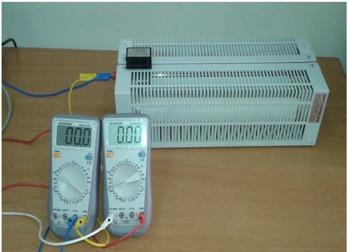
Figure (IV.10): Expérience d'étude des caractéristiques (I-V) des panneaux solaires.
