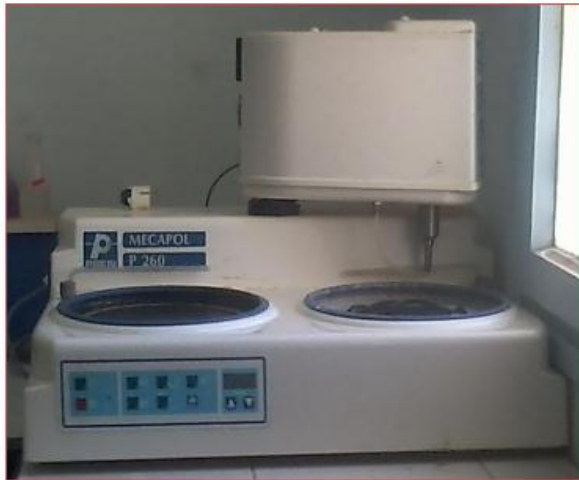
Figure III.4: Schéma de polisseuse utilisé dans le polissage mécanique.
