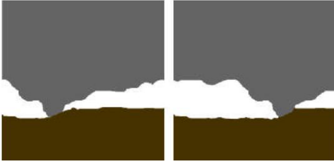
Figure I.4 : Mécanisme d'usure abrasive.
