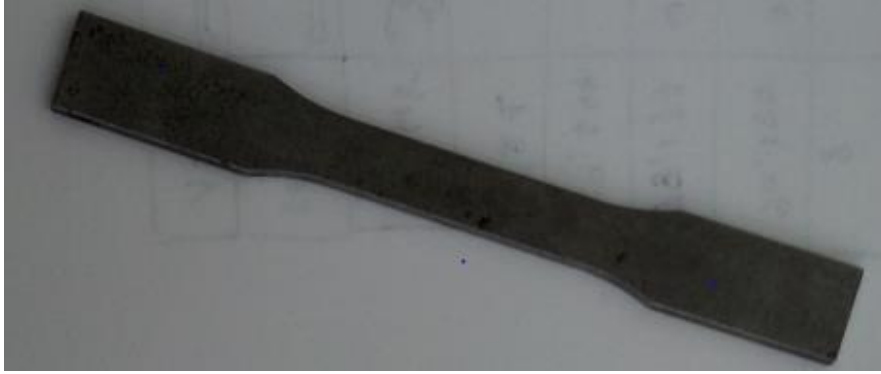
Figure II.9. Les éprouvettes pour l'essai de traction normalisées
