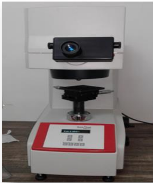
Figure II.12. Microduremètre Vickers type Zwik-Roell.
