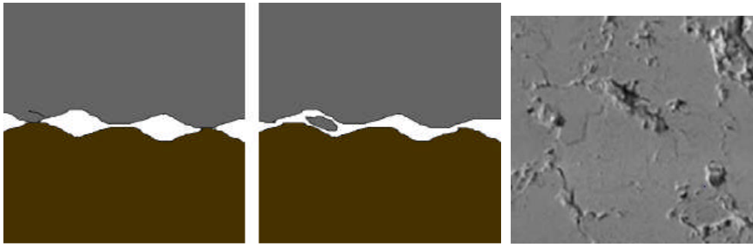
Figure I.10 : Mécanisme d'usure par fatigue .
