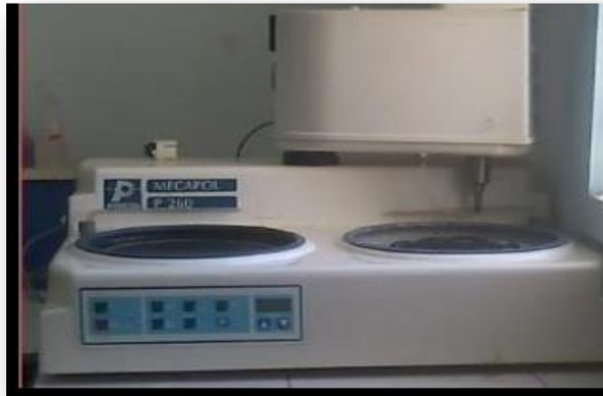
Figure II.1 : Polisseur à disque (MECAPOLE 250)
