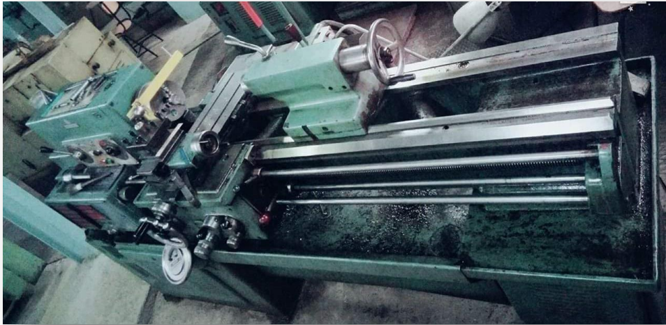
Figure II.5. tour parallèle de marque MACO à tourelle revolver.
