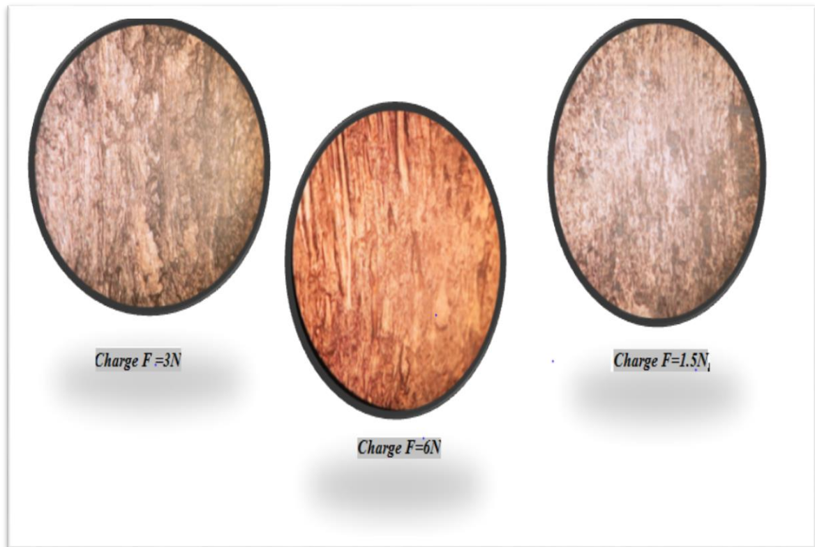
La Figure III.3. Evolution de la surface de contact des disques après les tests de frottement
