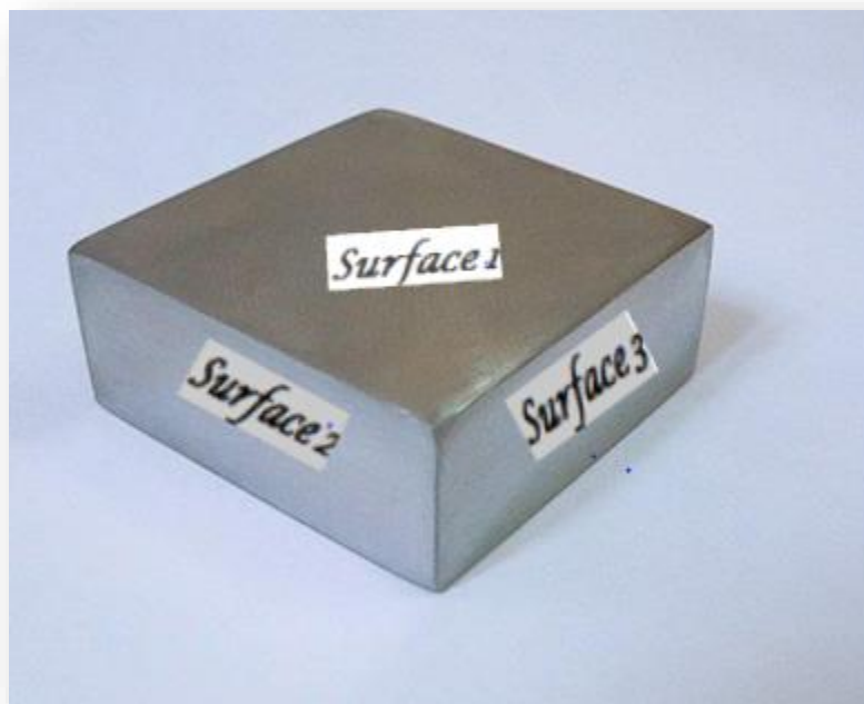
Figure III.6. Différentes plages pour la mesure de la microdureté.
