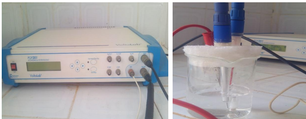
Figure.18. Montage de voltalab PGP201
