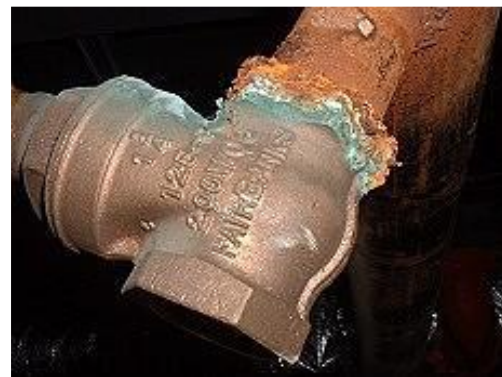
Figure.I.3. Corrosion galvanique résultante d'un assemblage de deux métaux différents : robinet en cuivre et conduite en acier galvanisé.
