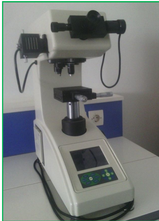
Figure III.6: Microduromètre de pénétration Vickers
