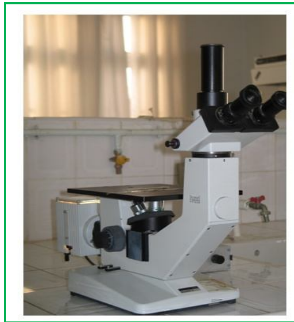
Figure III.3 : Microscope optique de type Hund WETZLAR.
