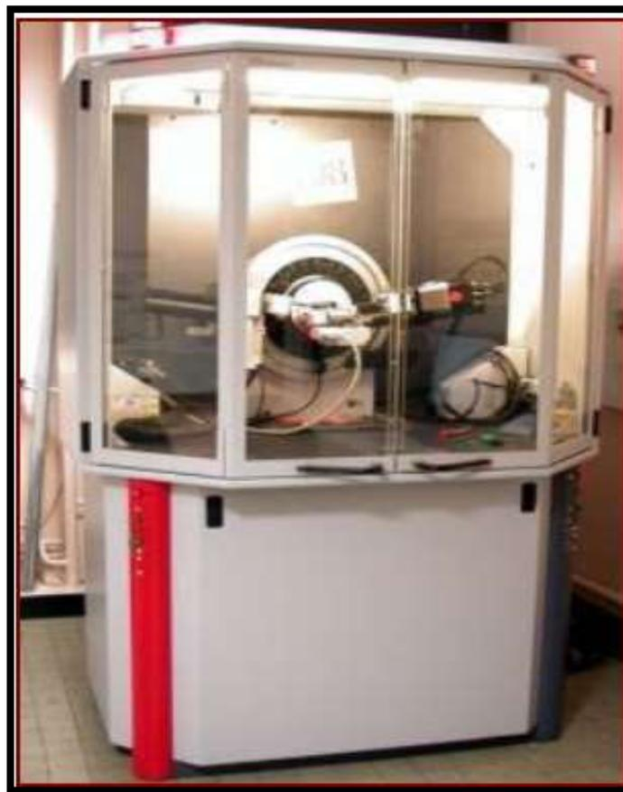
*Figure (II.11) : diffractomètre de type (D8 ADVANCE) [44].*
