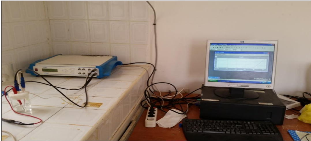
Figure III.8 : Dispositif expérimental du test de polarisation potentiodynamique.
