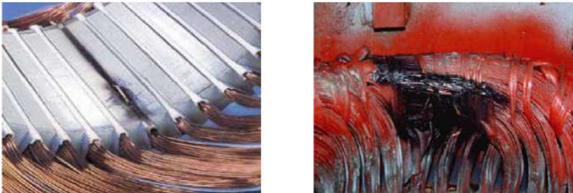
Fig.I.13 : Exemples de dégâts dus au défaut de court-circuit statorique d'un moteur asynchrone.
