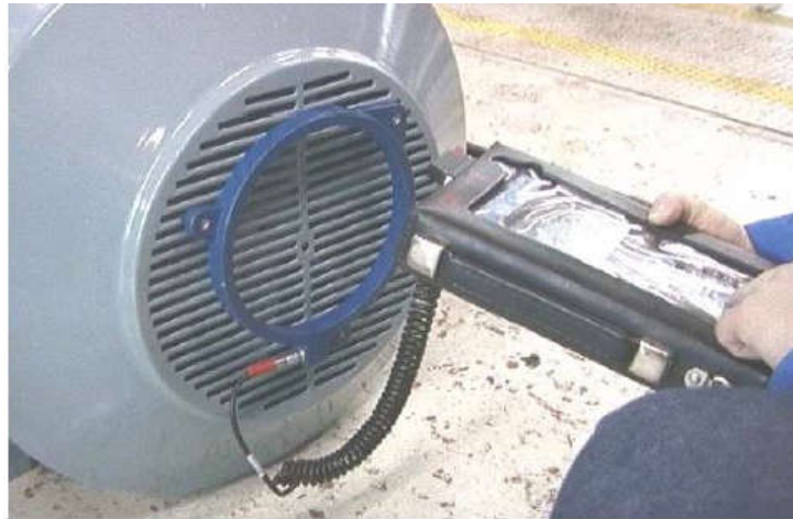
Fig.III.7 : Mesure du flux axial [27].
