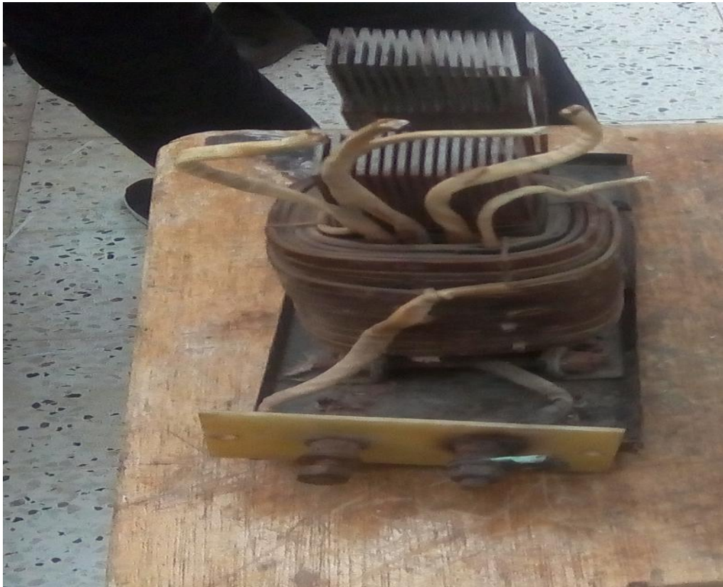
Fig. (III.2): Bobinage primaire endommagé (gauche) et secondaire saint (droit)
