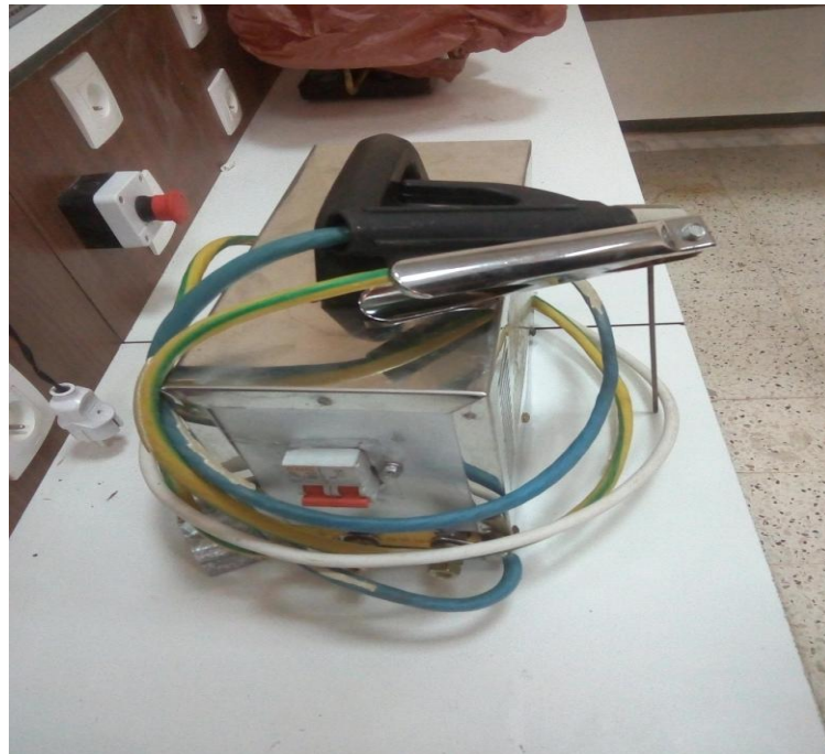
Fig. (III.19) : le poste soudage et termine
