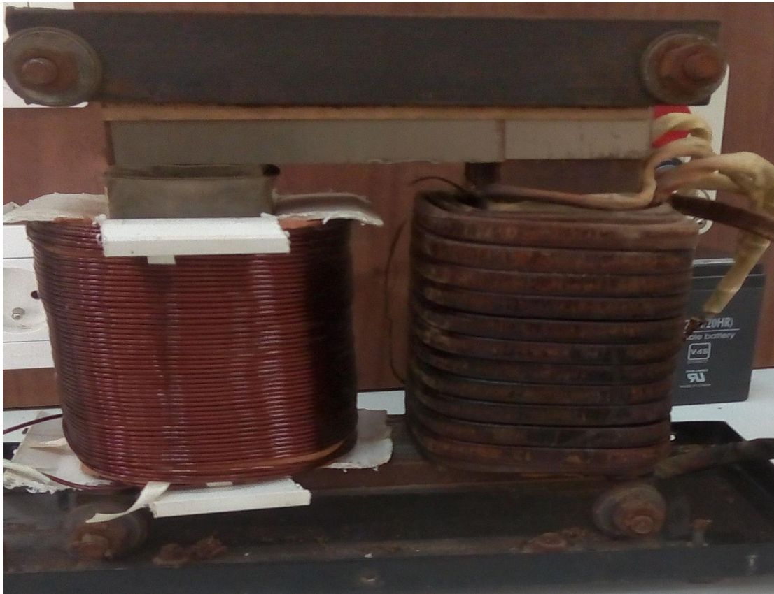
Fig. (III.13) : le circuit magnétique avec les deux bobines placé
