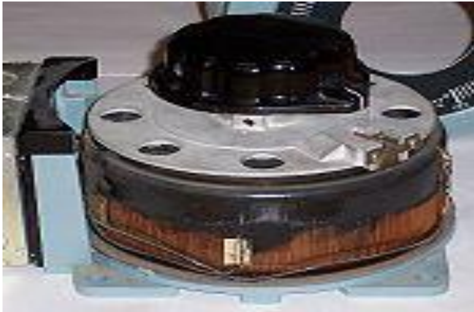
Fig. (II.3) : transformateur variable
