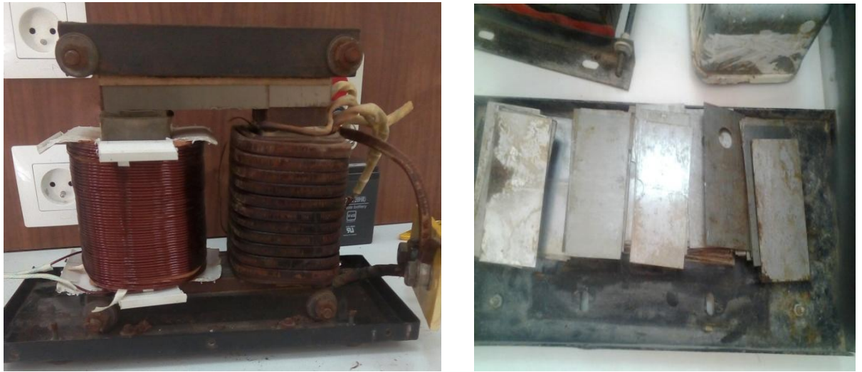
Fig. (III.12) : le lame et comment fermeture le circuit magnétique
