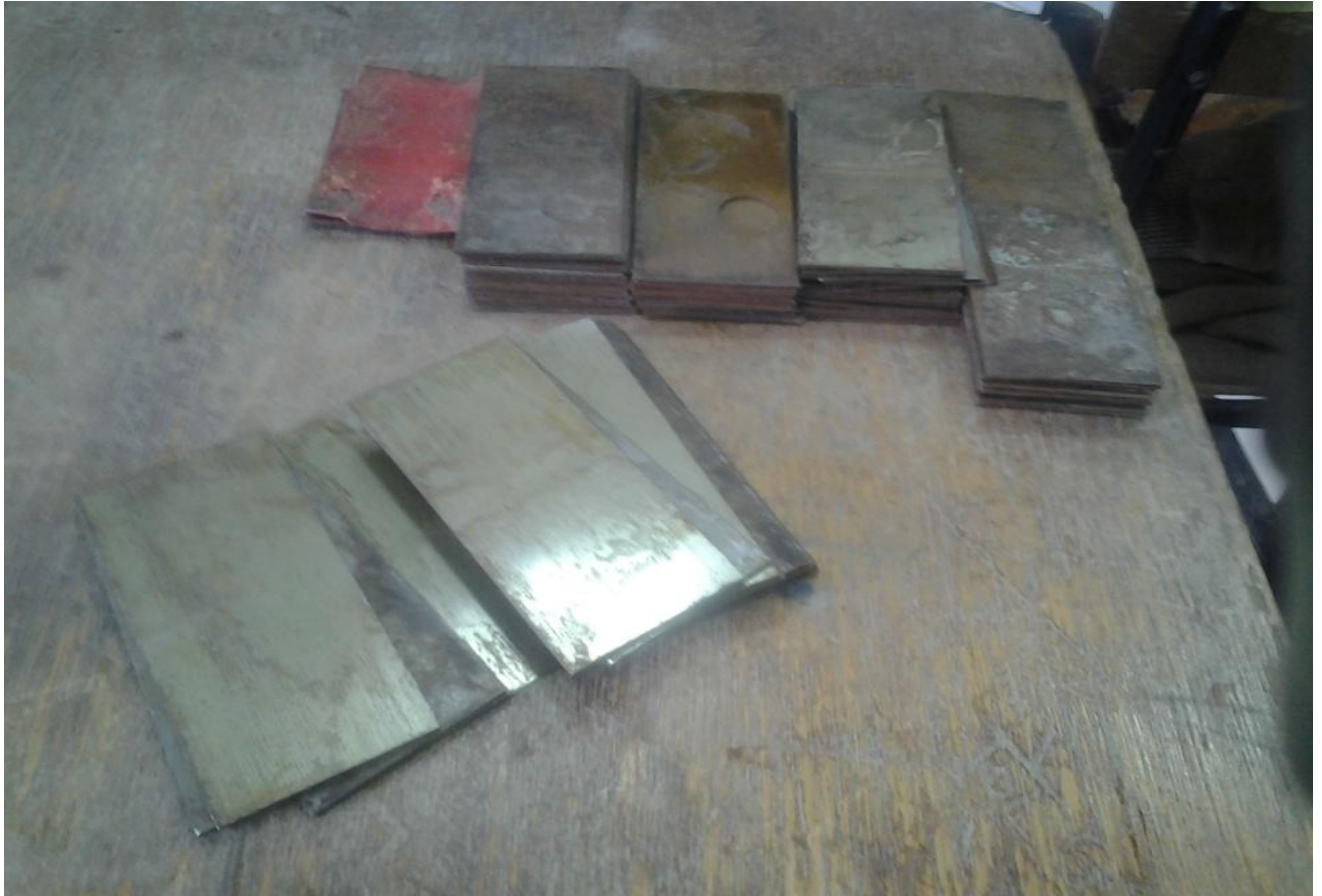
Fig. (III.4) : Tôles magnétiques utilisées dans la fabrication du circuit magnétique.
