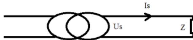
Figure (III. 19) : Schéma électrique simplifié du transformateur de tensions [38].
