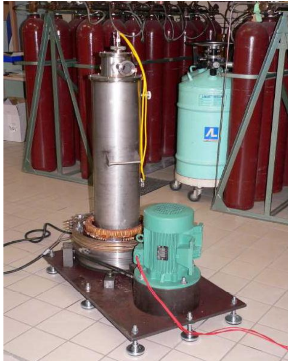
Figure III. 13 Moteur supraconducteur à concentration de flux, 20kW-750tr/min. [5]
