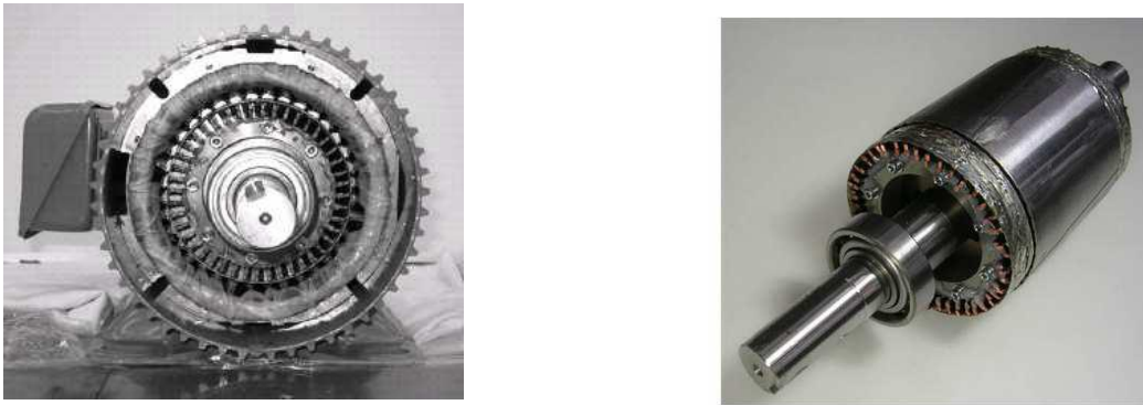
Figure III.19. Moteur asynchrone supraconducteur, 1.3kW-1800tr/min) [39].
