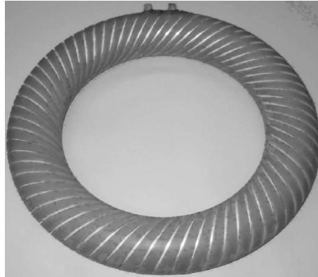
Figure II.3 : Configuration toroïdale en hélice avec des efforts compensés [12].
