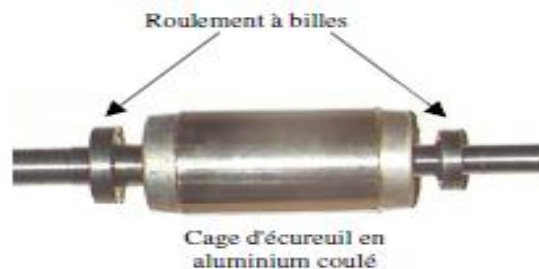
Figure (I.2). Le rotor a cage d'une machine asynchrone
