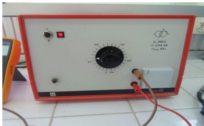
Figure IV. 6. Générateur de tension variable
