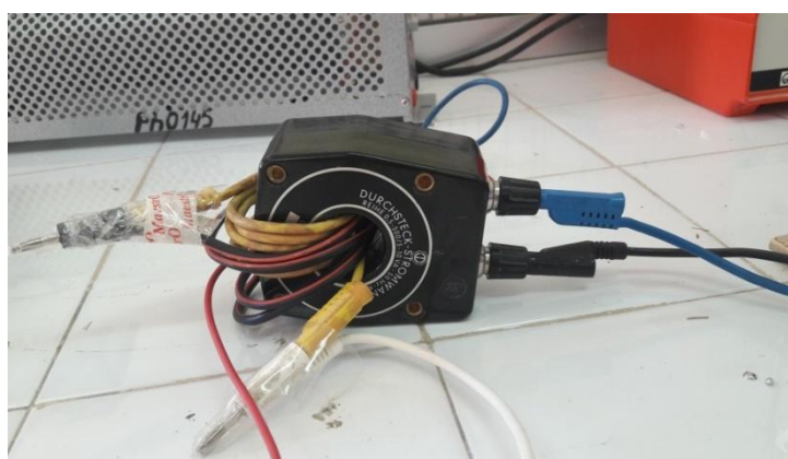
Figure IV. 8. Transformateur de courant de rapport 1/10
