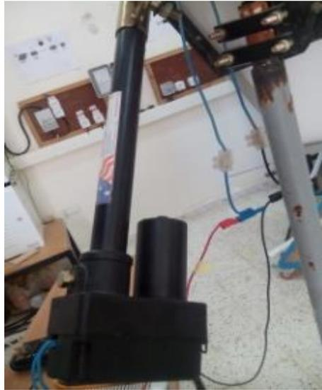
**Figure III-22:** Moteur à courant continu utilisé dans ce projet (vérin)
