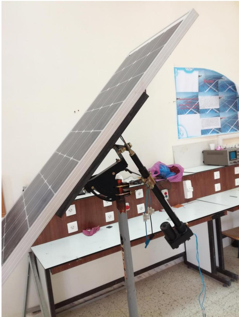
**Figure III-28** : le panneau solaire avec le suiveur
