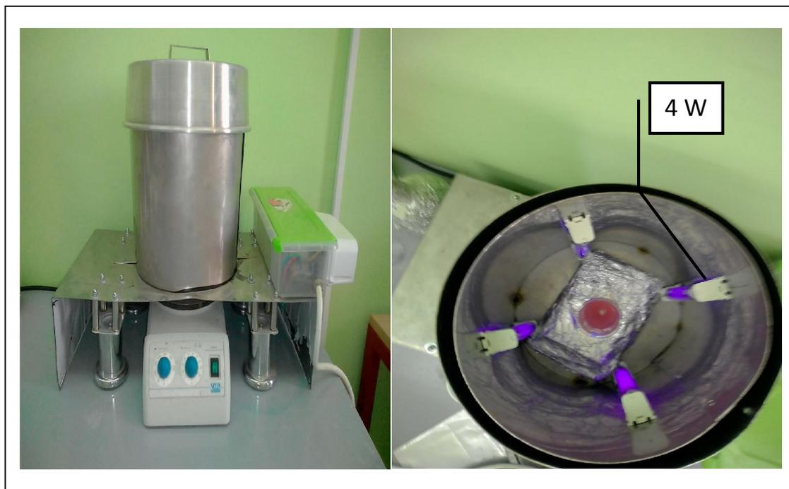
Figure IV. 1: Photoreacteur a lump UV
