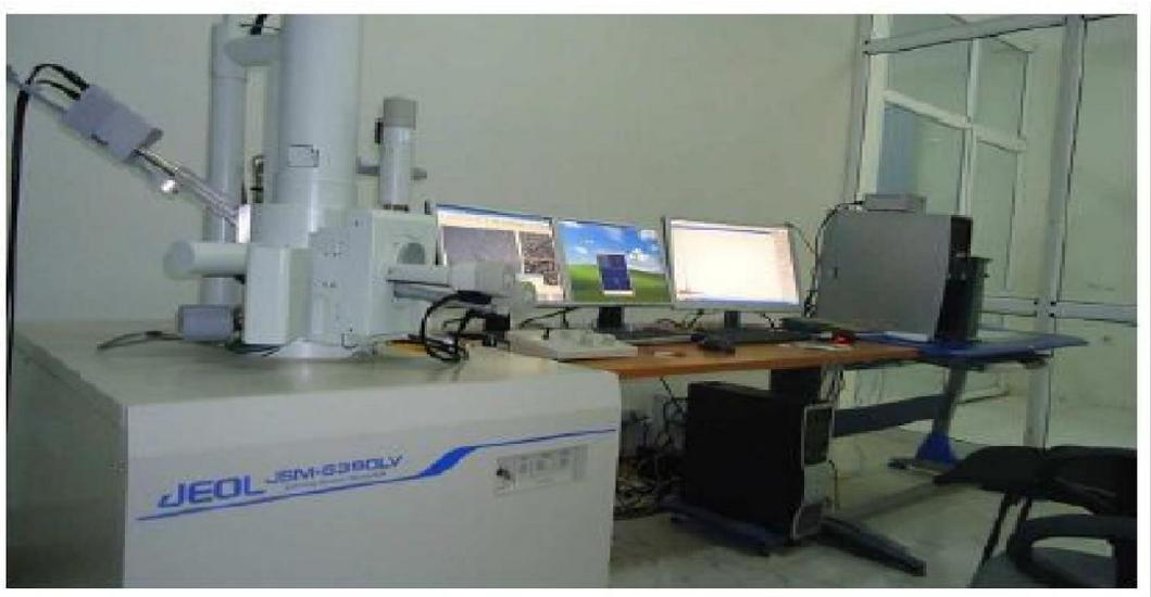
Figure II.8 : Microscopie Electronique à Balayage MEB
