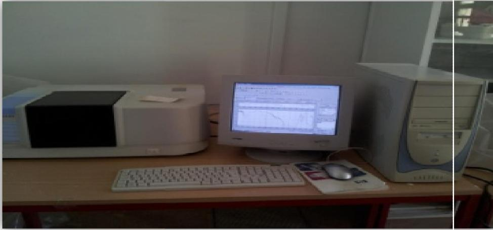
**Figure II.7:** Spectrophotomètre FTIR Shimadzu IR- 8400S.
