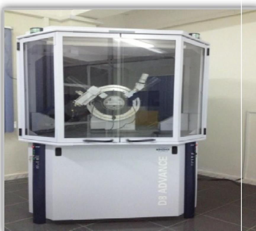
**Figure II.4:** Diffractomètre de marque BRUKER –AXS type D8
