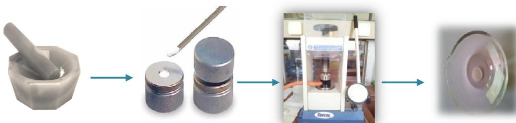
**Figure II.6 :** Préparation de la pastille (KBr + échantillon) pour analyse infrarouge.
