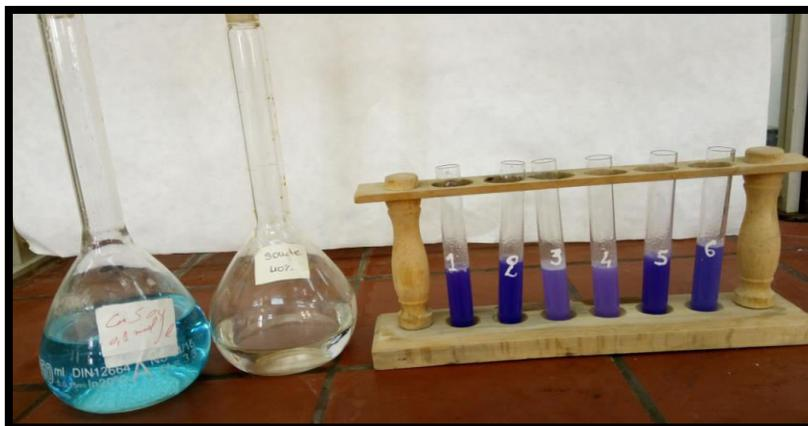
Figure IV.13 : résultats de test biuret sur le protéine
