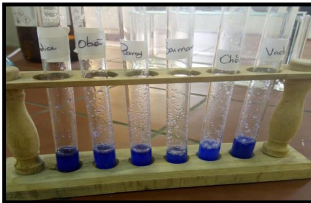
**Figure IV.10** : Résultat de test Biuret sur la caséine
