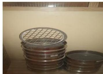
Figure 2.1. : Série des tamis utilisé pendant les essais granulométriques (source internet)
