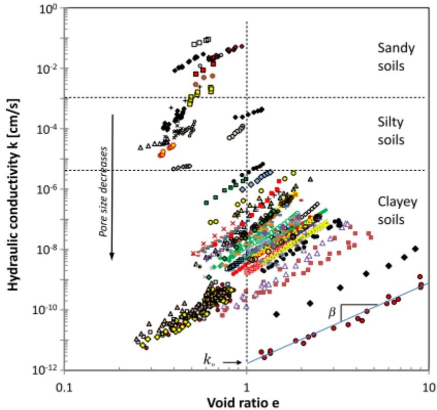
Figure. 1.2. Conductivité hydraulique en fonction de l'indice de vide. Les données recueillies pour naturel et remodelé sédiments, des sables grossiers aux argiles à grains fins (Ren et Santamarina 2017)
