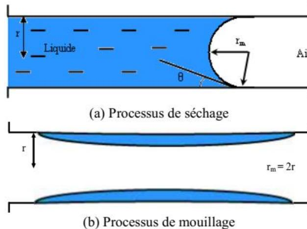
Figure 3.6. Schéma explicatif des processus de séchage et mouillage dans le réseau poreux constitué de cylindres de rayon  $r$ , ( $r_m$  est le rayon du ménisque de l'interface air-eau) (d'après Do, 1998)
