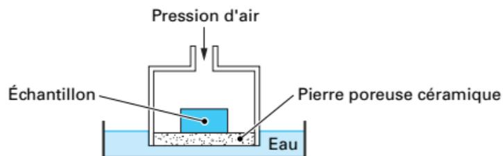
Figure 1.6. Cellule de Richards pour le contrôle de succion par translation d'axe(Technique de l'ingénieur 2012)
