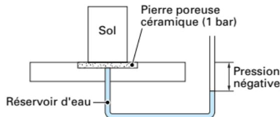
Figure 1.9.Principe de la mesure de la succion par tensiométrie(Technique de l'ingénieur 2012)
