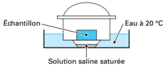
Figure 1.8. Contrôle de succion par phase vapeur (Technique de l'ingénieur 2012)
