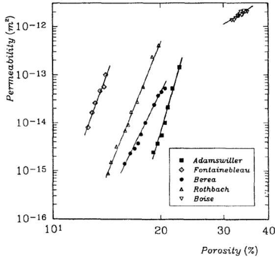
Figure 1-1 – Evolution de la perméabilité en fonction de la porosité des cinq types de matériaux (David et al. 1994)
