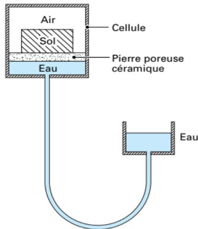
Figure 1.5.Principe de la plaque tensiométrique (faibles succions)(Technique de l'ingénieur 2012)
