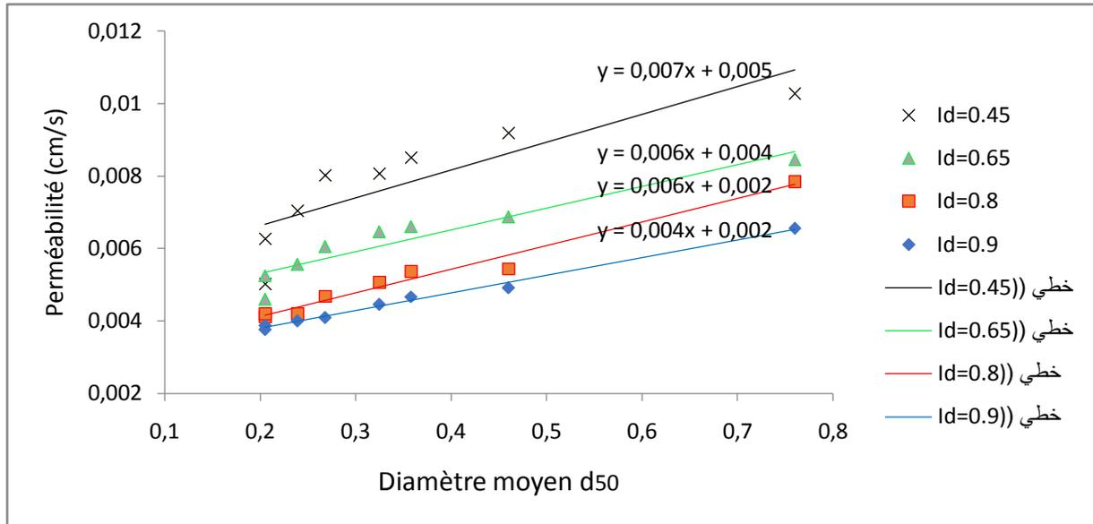
Figure.3.2. Perméabilité des sables en fonction de diamètre moyen
