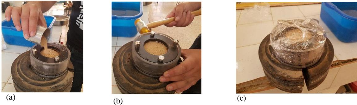
Figure 2.9. Préparation d'une éprouvette de sable, a) versement d'une petite quantité pour former une couche, b) compactage et vibration, c) recouvrement de l'éprouvette par un film cellophane afin d'éviter l'échange d'humidité avec l'extérieure
