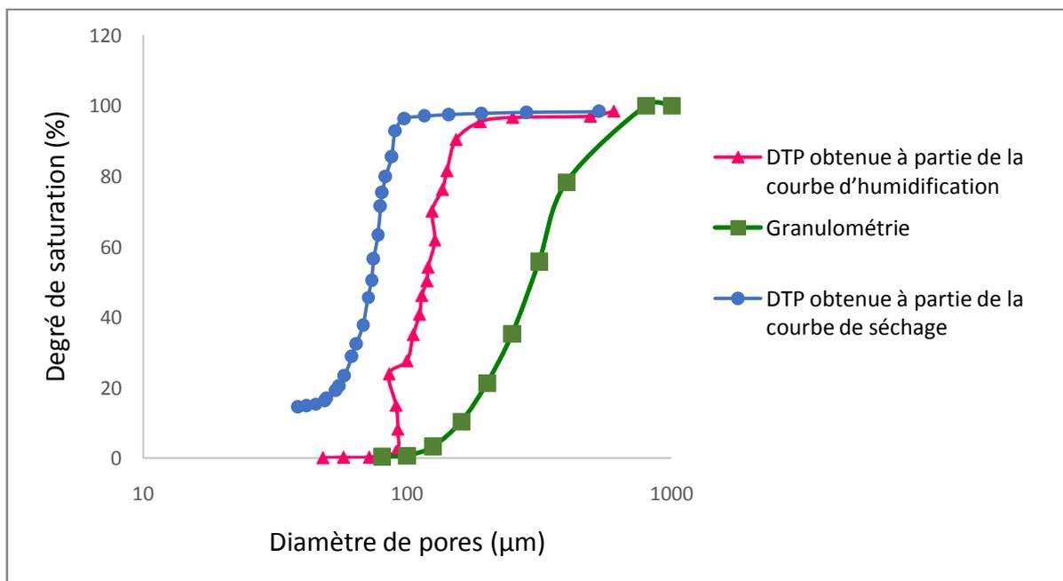
Figure 3.5. Distribution de la taille des pores et de la taille des grains d'un sable ( $I_D = 0,9$ )
