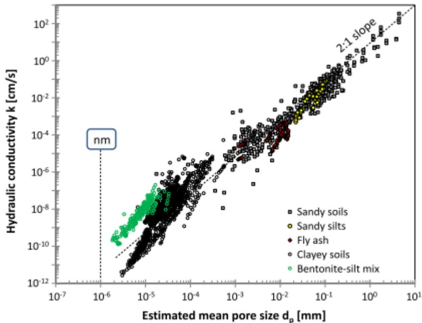
Figure. 1.3. Conductivité hydraulique mesurée  $k$  par rapport à la taille moyenne estimée des pores  $d_p$  (Ren et Santamarina 2017)
