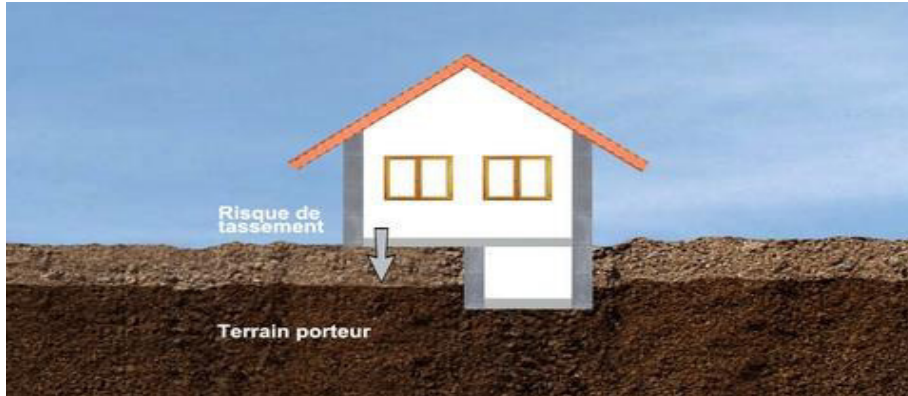
Figure 2 : Schéma Explicatif des phénomènes: Tassement
