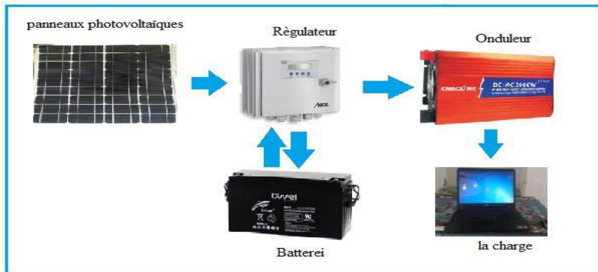
Figure 3.10: Schéma synoptique du système PV autonome.
