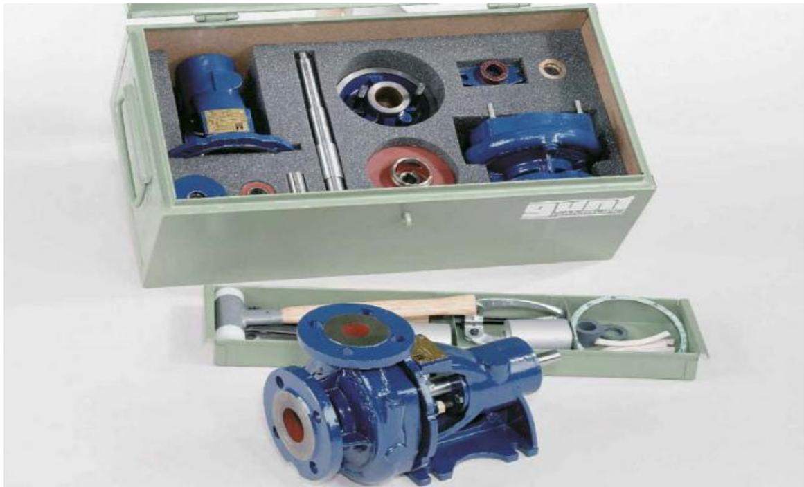
Figure .II.12.pompe centrifuge MT 180
