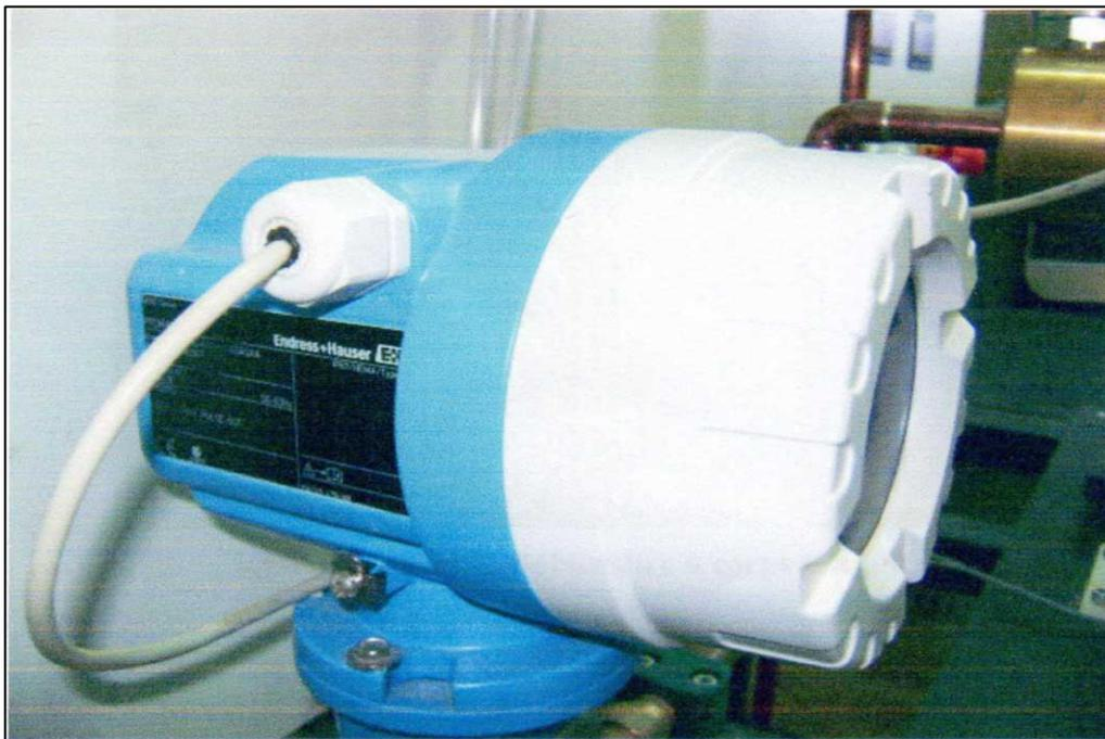
Figure .I.4 . Débitmètre magnéto- inductive
