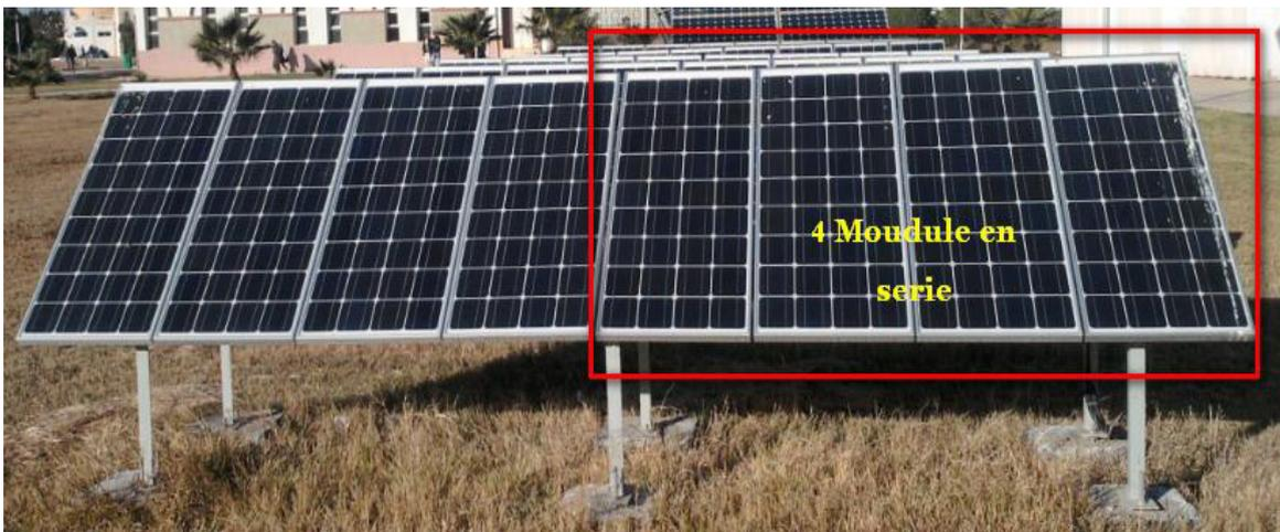
Figure .II.4. Schéma de 4 modules en série de l'université de Biskra
