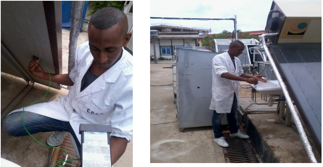
Figure 3.2- Emplacement des thermocouples sur l'installation (BOUZAREAH).
