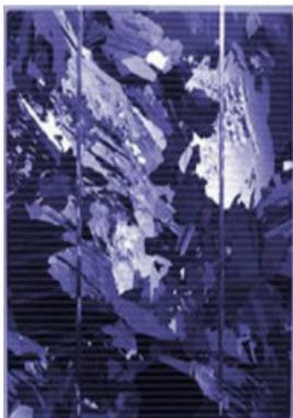
Fig. I.9 . Photos de cellule solaire polycristallin [4] .
