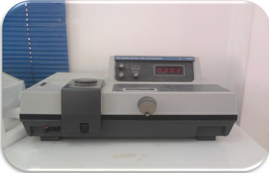
**Figure 1:** spectrophotomètre PYE UNICAM SP6-350
