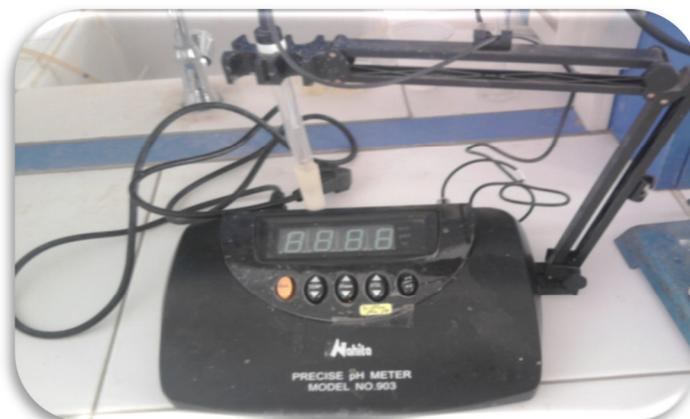
**Figure 2:** pH-mètre model Nahita NO-903.
