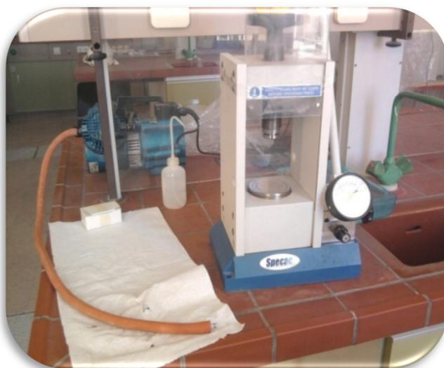
**Figure 6:** Specac pour la préparation des pastilles.
