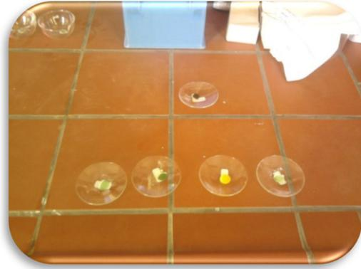
**Figure 7:** préparation des pastilles pour l'analyse infra rouge.
