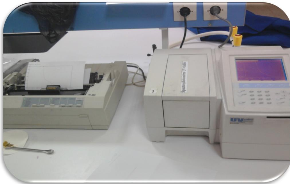
**Figure 5:** L'ultraviolet - Visible (UV/Vis) SHIMADZU type UV mini 1240.
