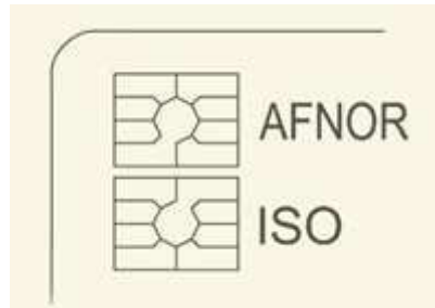
Figure [I.2] : positionnement des contacts ISO et AFNOR.
