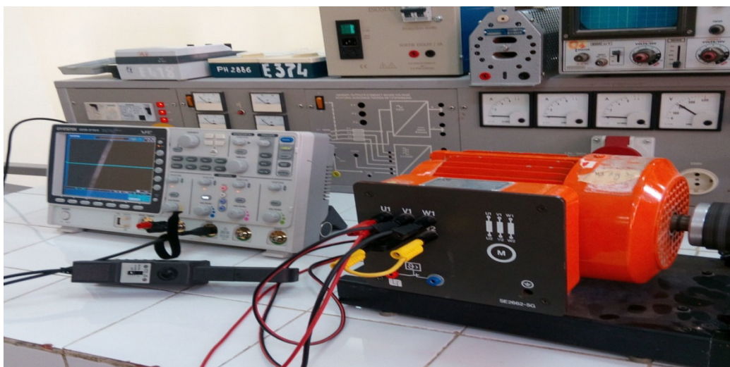
Figure III-5-Banc d'essai pour l'identification des paramètres mécaniques.
