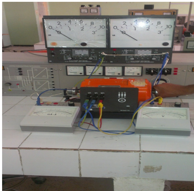
Figure III-2 : le montage d'essai à rotor bloqué.
