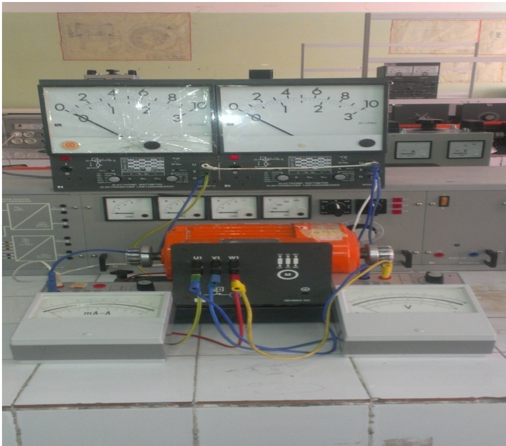
Figure III-3 : Le montage d'essai à vide .
