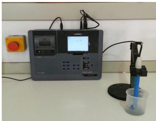
Figure 5: pH-mètre utilisé pour la mesure du pH des solutions.
