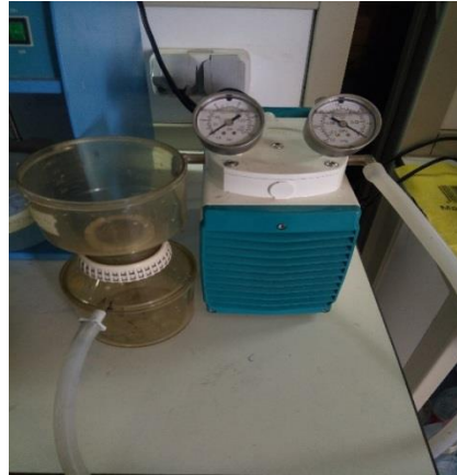
Figure 6: Système de séparation solide/liquide (filtration sous vide).
