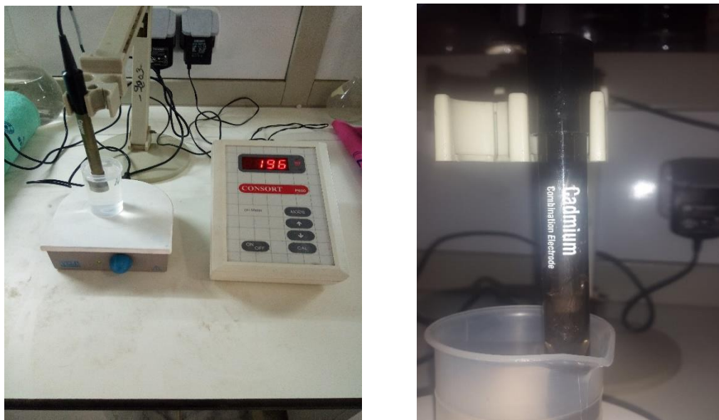
Figure 3: Appareillage utilisé pour le dosage des ions \text{Cd}^{2+} dans les solutions aqueuses.
