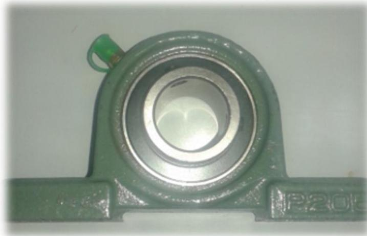
Figure (III-15) : représente le roulement de l'arbre.
