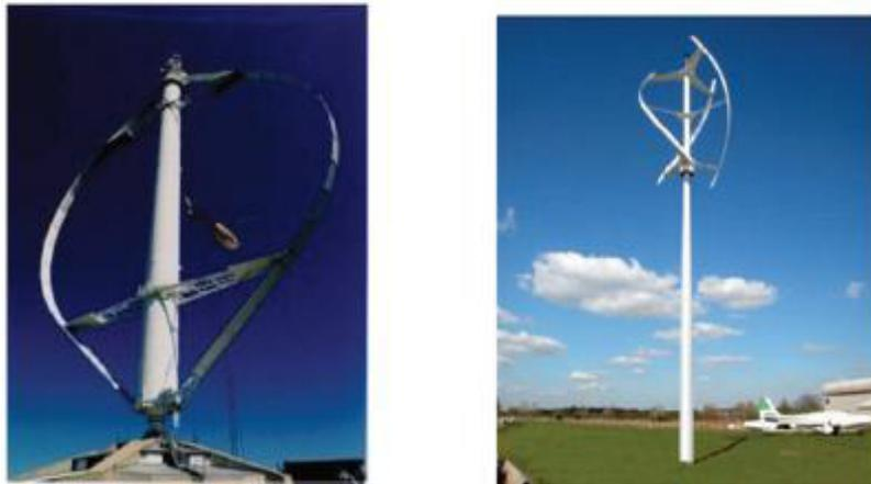
Figure I-7: éoliennes à axe vertical de type DARRIEUS [5].
