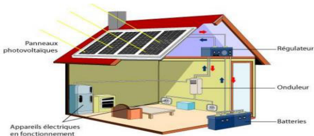
Figure (1.1) : Système solaire photovoltaïque. [06]
