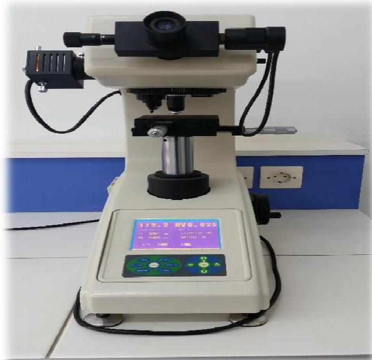
**Figure III.6:** la Microduremètre Vickers.
