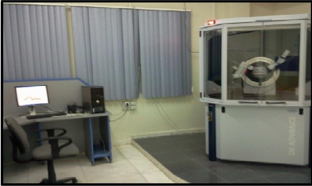
**Figure III .5:**Diffractomètre de type D8 Advance.
