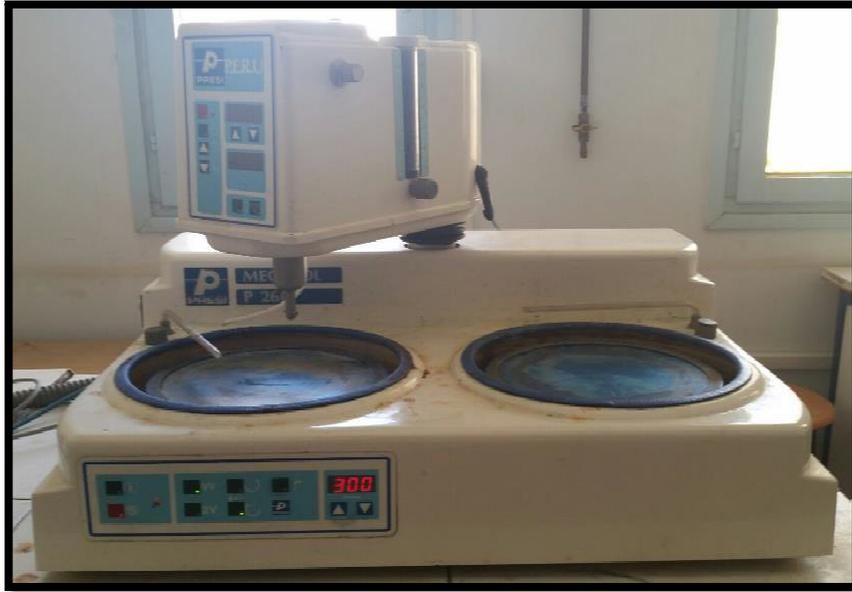
Figure III.2 :Polisseuse mécanique.
