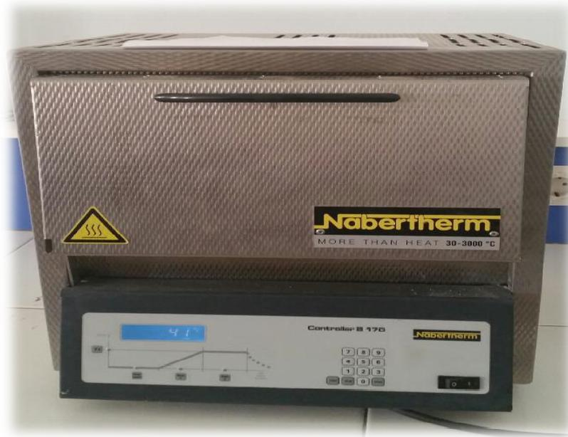
**Figure III.1 :** Four programmable pour traitement thermique.
