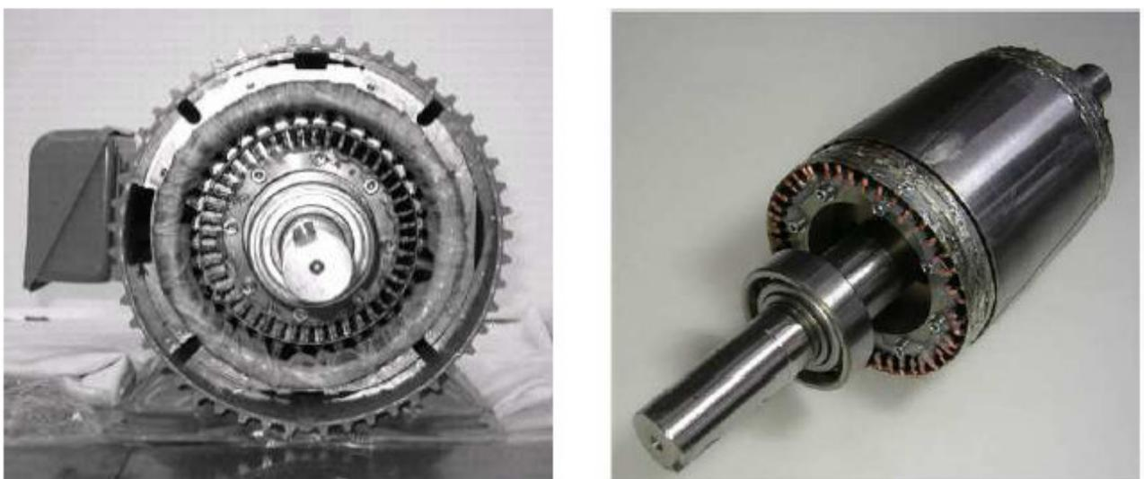
Figure. II.15. Moteur asynchrone supraconducteur, 1.3kW-1800tr/min) [7].
