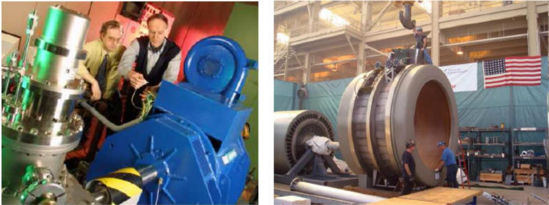
Figure. II.5. Moteur 400kW de Siemens 2002 (à gauche) et stator du moteur 36.5MW 2009 d'American Superconductor (à droite) [7].
