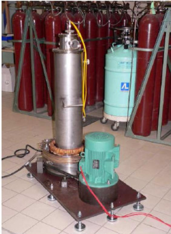
Figure.II.24. Moteur supraconducteur à concentration de flux, 20kW-750tr/min [7].
