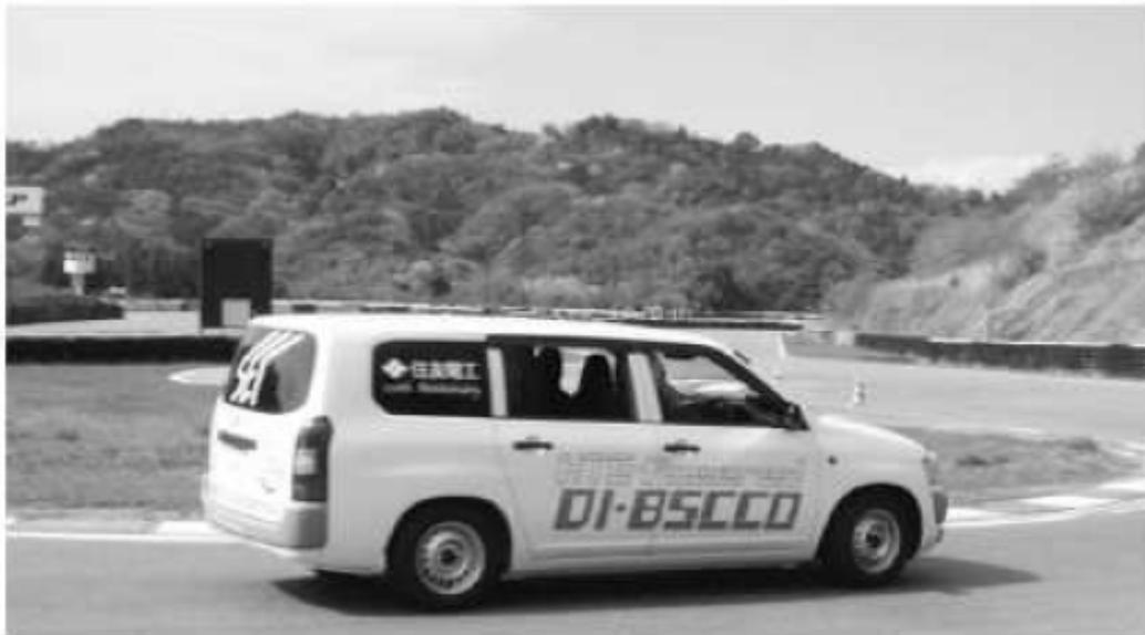
Figure. II.21. Voiture électrique supraconductrice [7].
