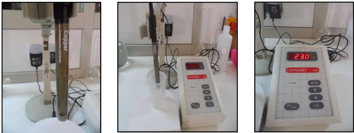
Figure 5 : Appareillage utilisé pour le dosage du cuivre dans les échantillons d'eau.
