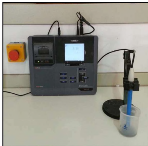
Figure 7 : pH mètre utilisé pour mesurer le pH des échantillons d'eau.
