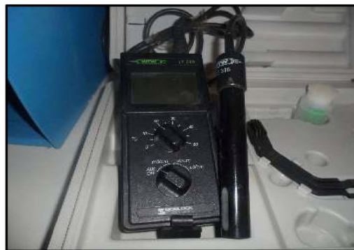
Figure 8 : Conductimètre utilisé pour mesurer la conductivité.
