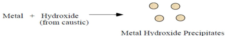
Figure 18 : Formation de l'hydroxyde du métal en présence de \text{NaOH}
