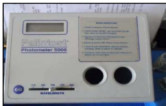
Figure 9 : Photomètre Palintest utilisé pour mesurer les concentrations des sulfates SO_4^{2-} .
