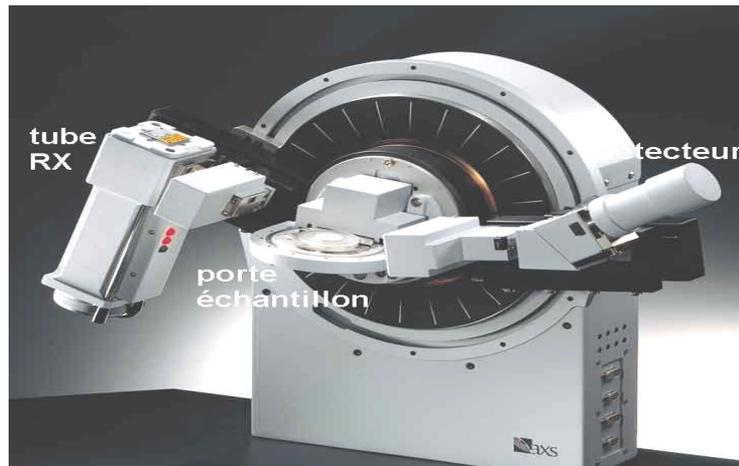
**Figure II.3** Goniomètre de la marque Bruker-AXS, type D8.
