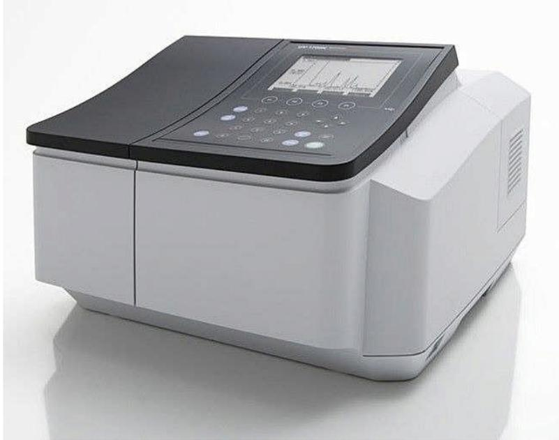
*Figure II.6 Dispositif expérimental de la spectroscopie UV-visible*
