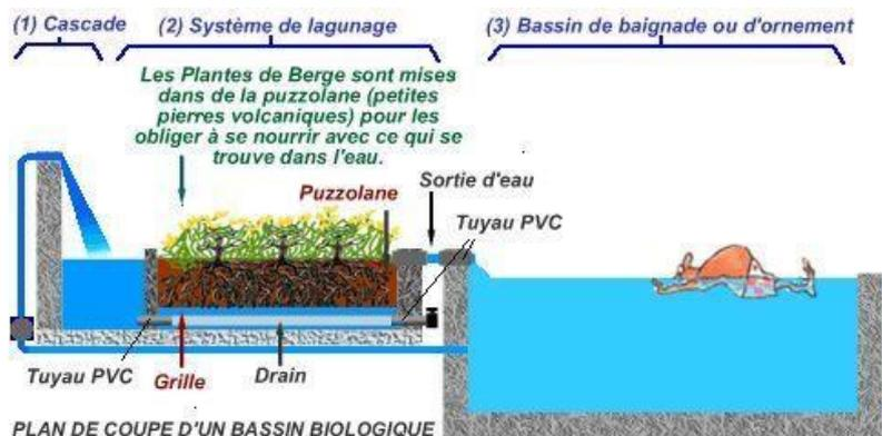
Figure 36 : exemple de liaison de drainage avec le plan d'eau
