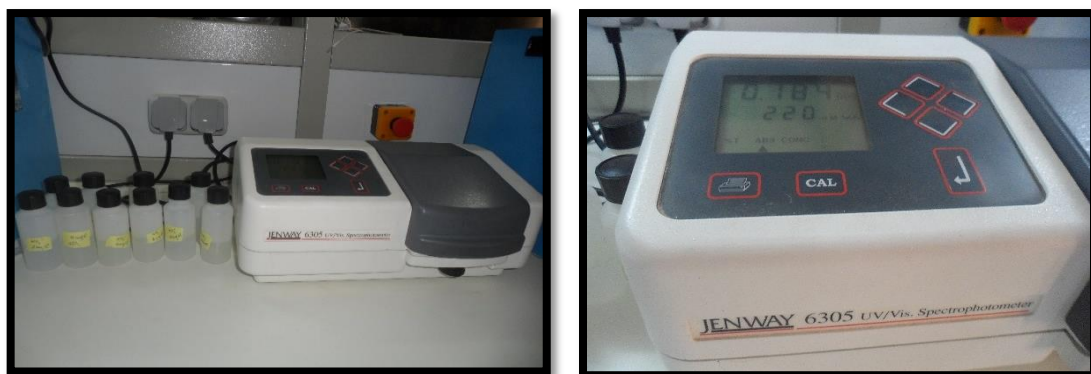
Figure 7 : Spectrophotomètre UV-visible utilisé pour le dosage des nitrates
