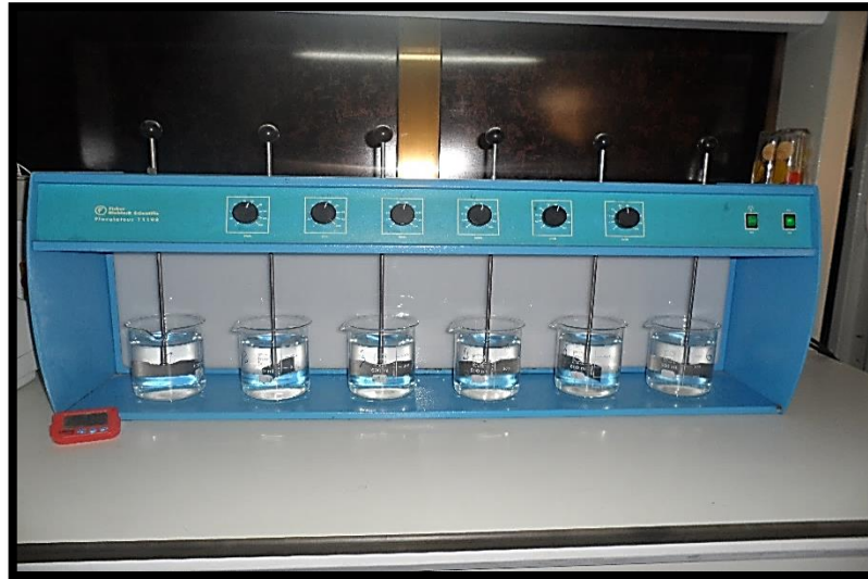
Figure 14 : Flocculateur utilisé pour les essais de coagulation-floculation.
