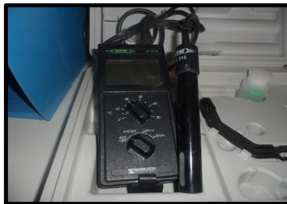
Figure 10 : Conductimètre utilisé pour la mesure de la conductivité des échantillons d'eau
