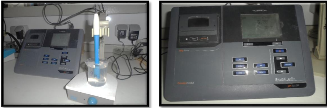
Figure 9 : pH mètre utilisé au cours des essais
