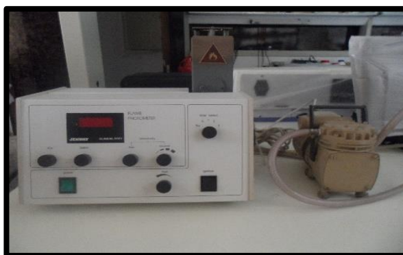
Figure 11 : Spectrophotomètre à flamme utilisé pour le dosage du sodium et du potassium
