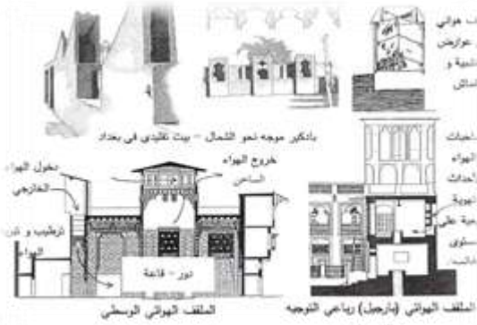
شكل (I-13): الملقف الهوائي الوسطي المصدر: (آية. س، 2001)
