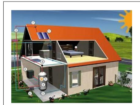
Figure 12 : typologie de l'énergie solaire thermique, (source Germain, G 2017)
