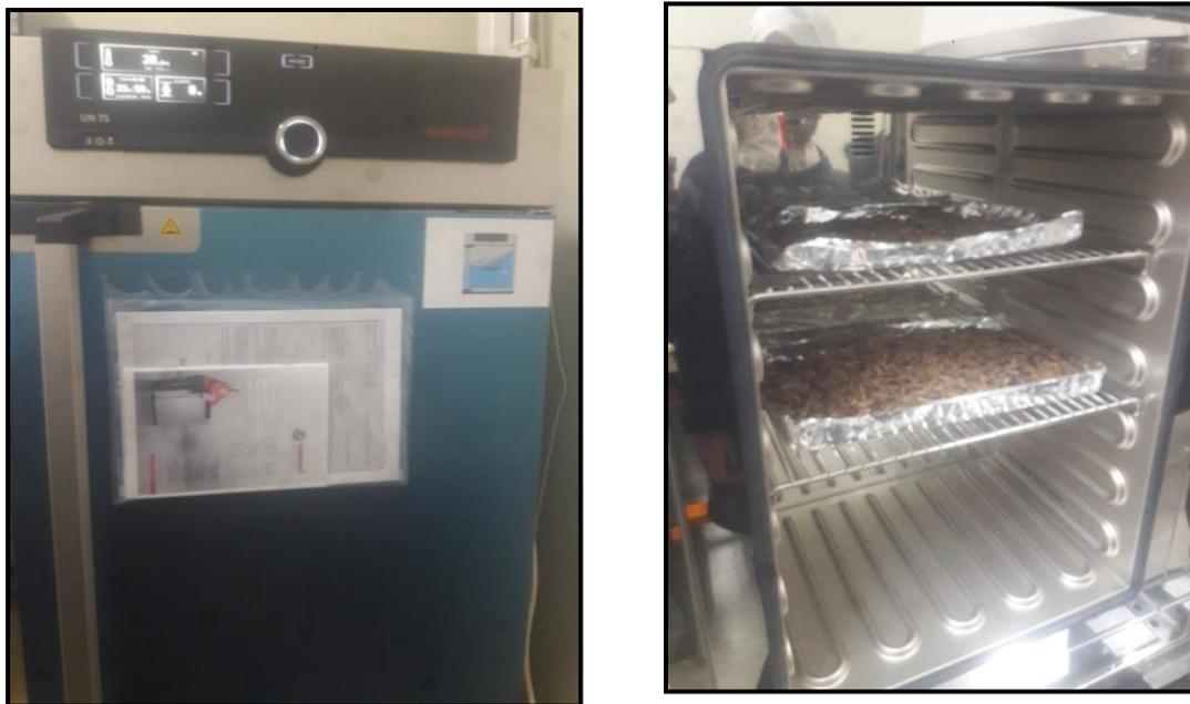
**Figure I.6** : Séchage des noyaux de dattes dans l'étuve
