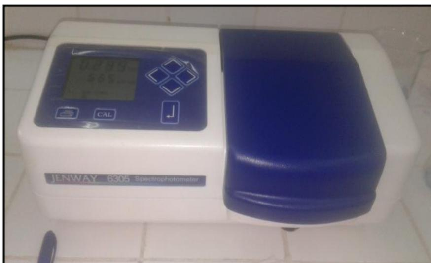
**Figure I.5 :** Spectrophotomètre UV- visible
