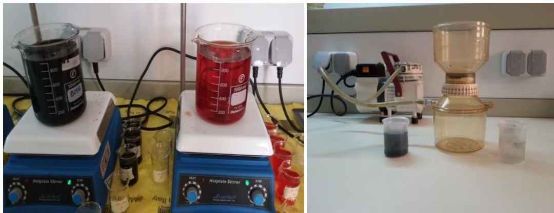
Figure 11: Cinétique d'adsorption du RC sur le CAP et le CAG et la Pompe de filtration sous vide
