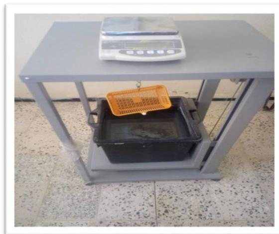
Photo III-13 : Bâti de pesée hydrostatique
