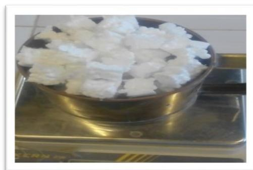
Photo III-09 : Mesure de masse volumique apparente et absolue du polystyrène
