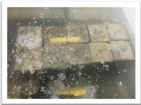
Photo III-22: Les échantillons conservés dans l'eau seulement
