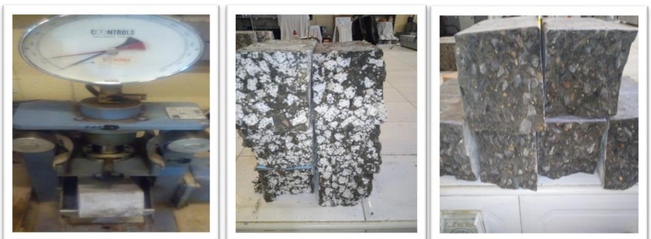
**Photo III-15 - Machine d'essai de flexion.**
