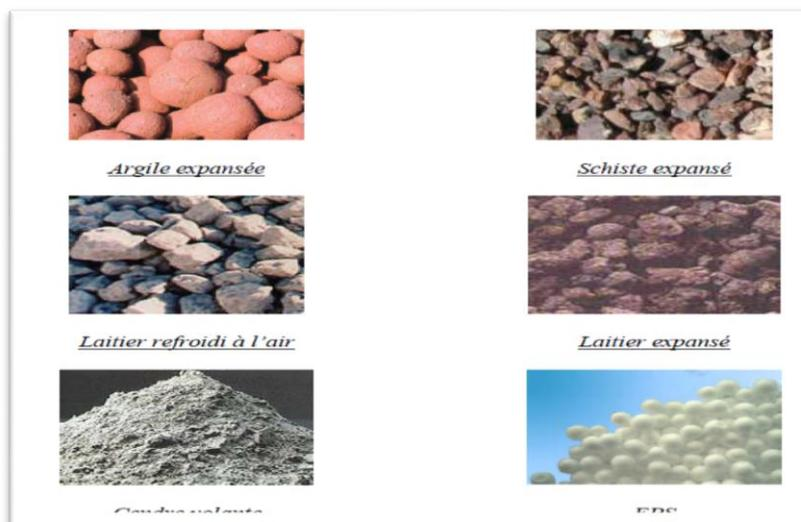
Figure I-04 : Différents granulats légers artificiels [12].
