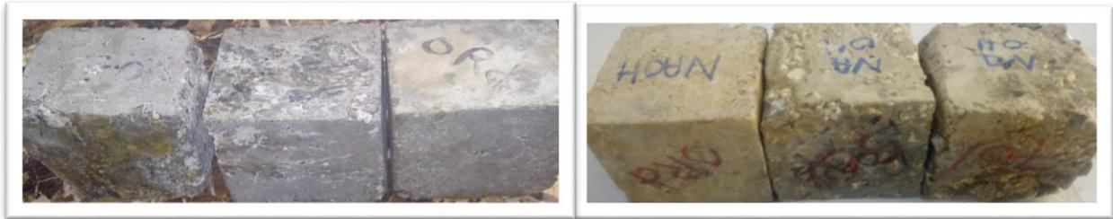
**Photo IV-11 : Les éprouvette avant et après l'attaque chimique de NaOH**
