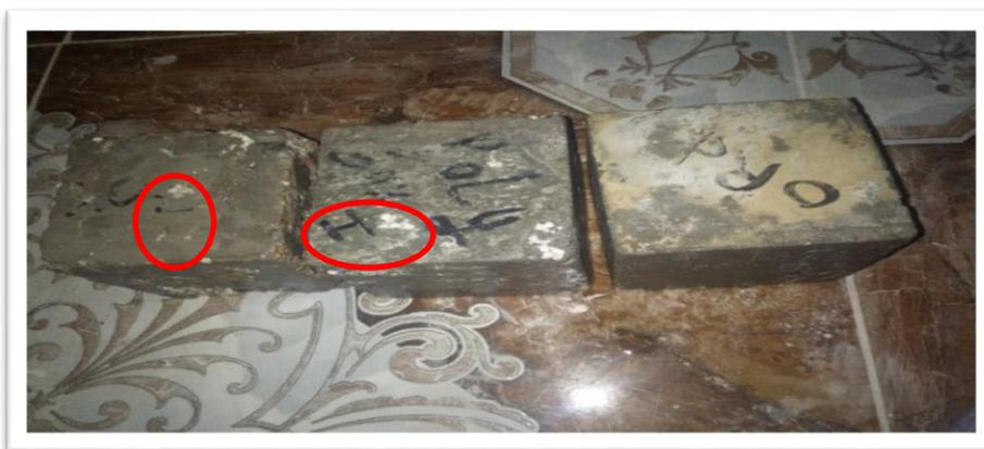
**Photo IV-02 :Les éprouvette du gel-dégel au 10<sup>eme</sup> cycles**
