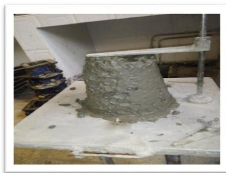
**Photo III-12 : Essai du Slump-test.**
