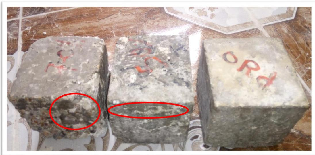
**Photo IV-04 : Les éprouvette du gel-dégel au 50<sup>eme</sup> cycles**
