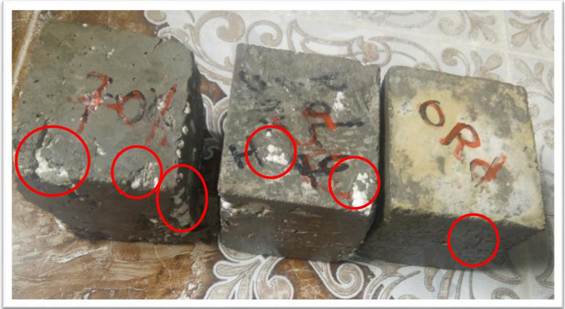
**Photo IV-03: Les éprouvette du gel-dégel au 25<sup>eme</sup> cycles**
