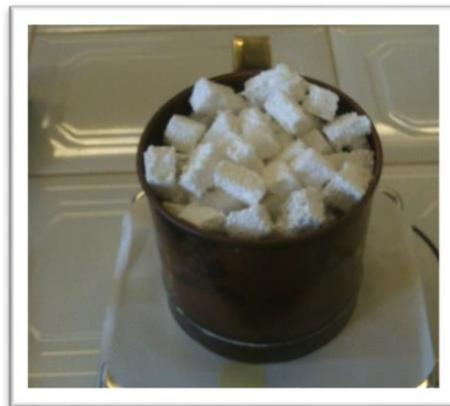
**Photo- III-08 : Granulats de polystyrène**
