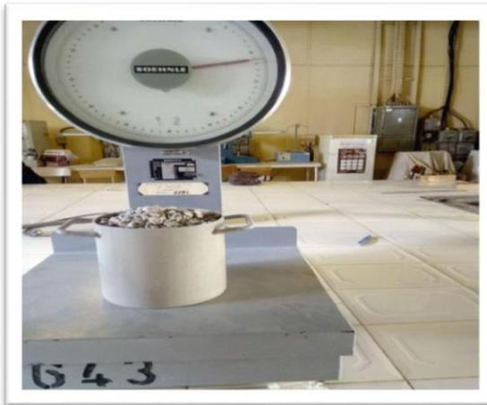
**Photo III-05 : La masse volumique apparente absolue de gravier.**
