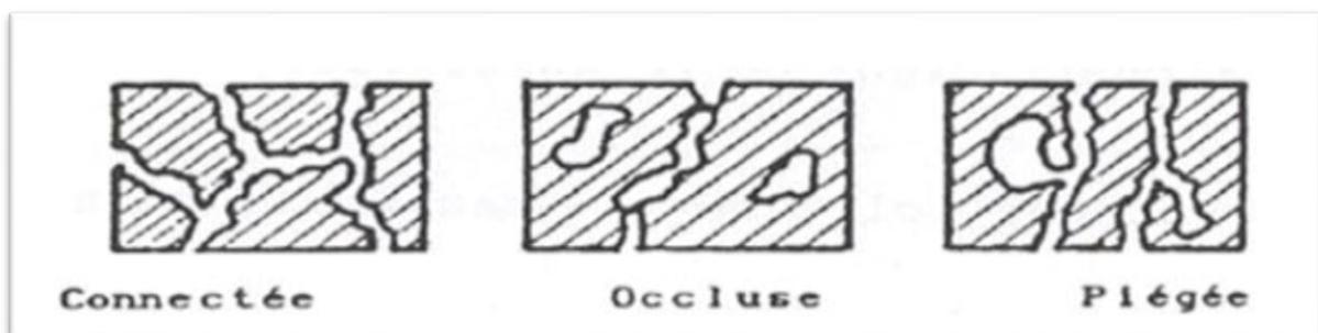
**Figure II-02 : Les trois types de porosité présente dans les matériaux [11].**
