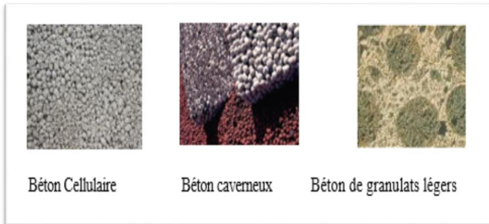
Figure I-01: Représentation schématique des différents types de bétons légers [4]
