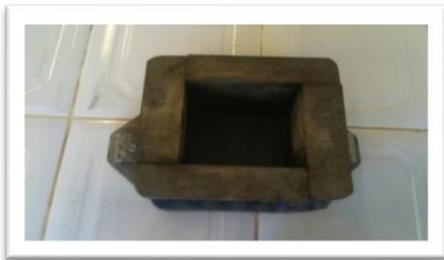
**Photo III-10 : moule pour éprouvette
