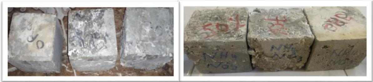
**Photo IV-09 : Les éprouvette avant et après l'attaque chimique de  $\text{NH}_4\text{NO}_3$**
