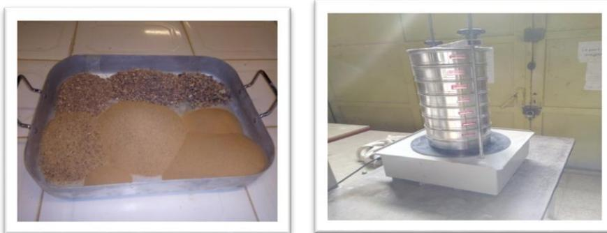
**Photo III-03 : l'analyse granulométrique de sable 0/5 de lioua**
