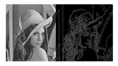
FIGURE 1.3: Edge detection example.
