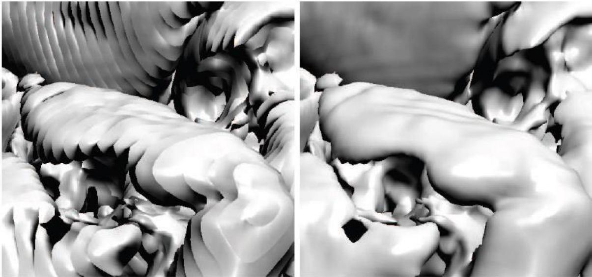
Figure 2.2. L'image de gauche illustre un petit détail du modèle de dragon asiatique avec un taux d'échantillonnage de 0,5. À droite, l'échantillonnage adaptatif augmente le taux d'échantillonnage à 4,0 proches de l'iso-surfaces. N
