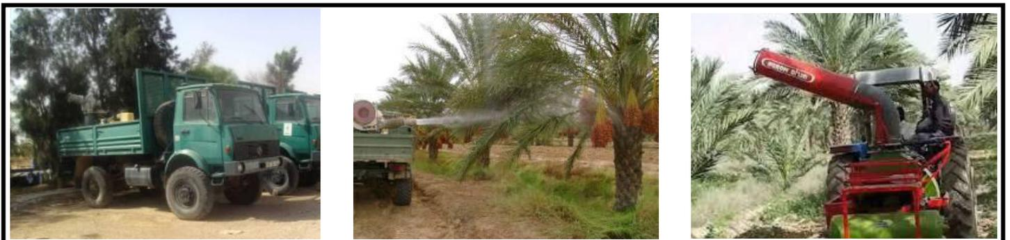
**Figure 50: Les pulvérisateurs portés par le camion ou par un tracteur agricole (Nourani, 2016).**
