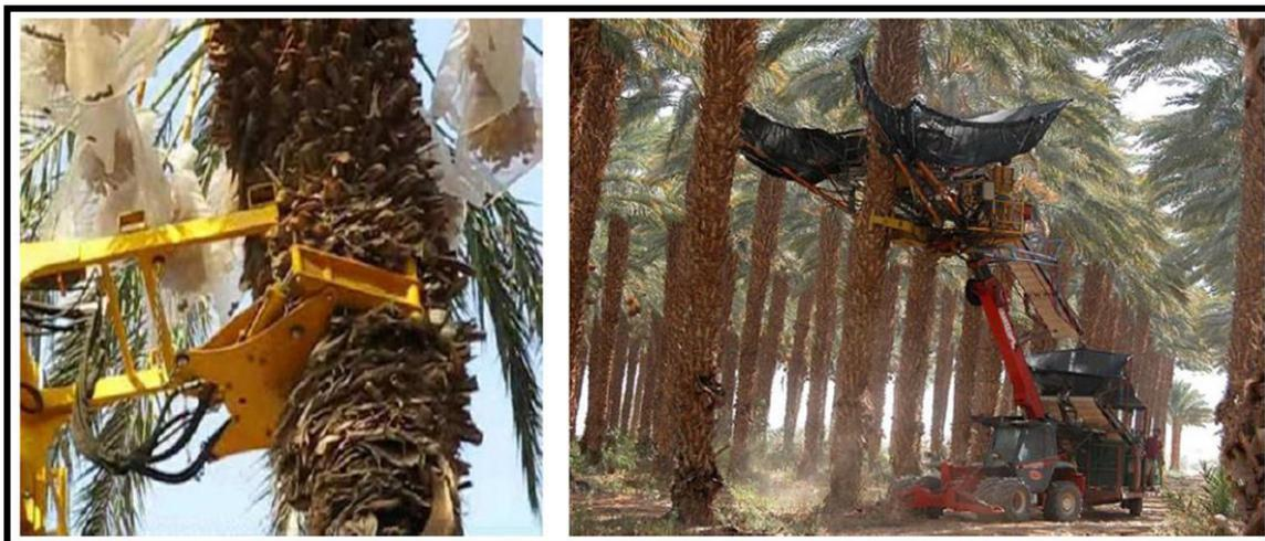
**Figure 64:** Exemple d'un système de récolte des dattes sèches «Stipe secoueur».
