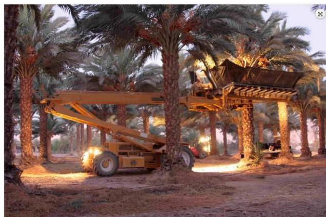
**Figure 61:** *Machine de récolte des dattes sèches par vibration.*
