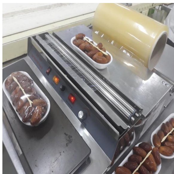
Figure 27: L'emballage semis-mécanique dans unité de conditionnement « Haddoud Salim » source :(original, 2019).
