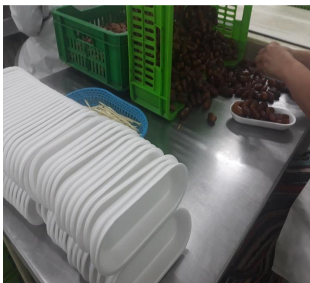
Figure 27: L'emballage semis-mécanique dans unité de conditionnement « Haddoud Salim » source :(original, 2019).
