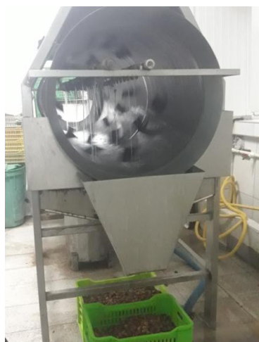
Figure 22 : machine lavage des dattes dans Unité« Haddoud Salim »
