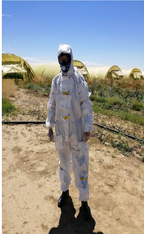
Figure 02 : Répartition des patches sur le corps de l'opérateur (Original, 2019).
